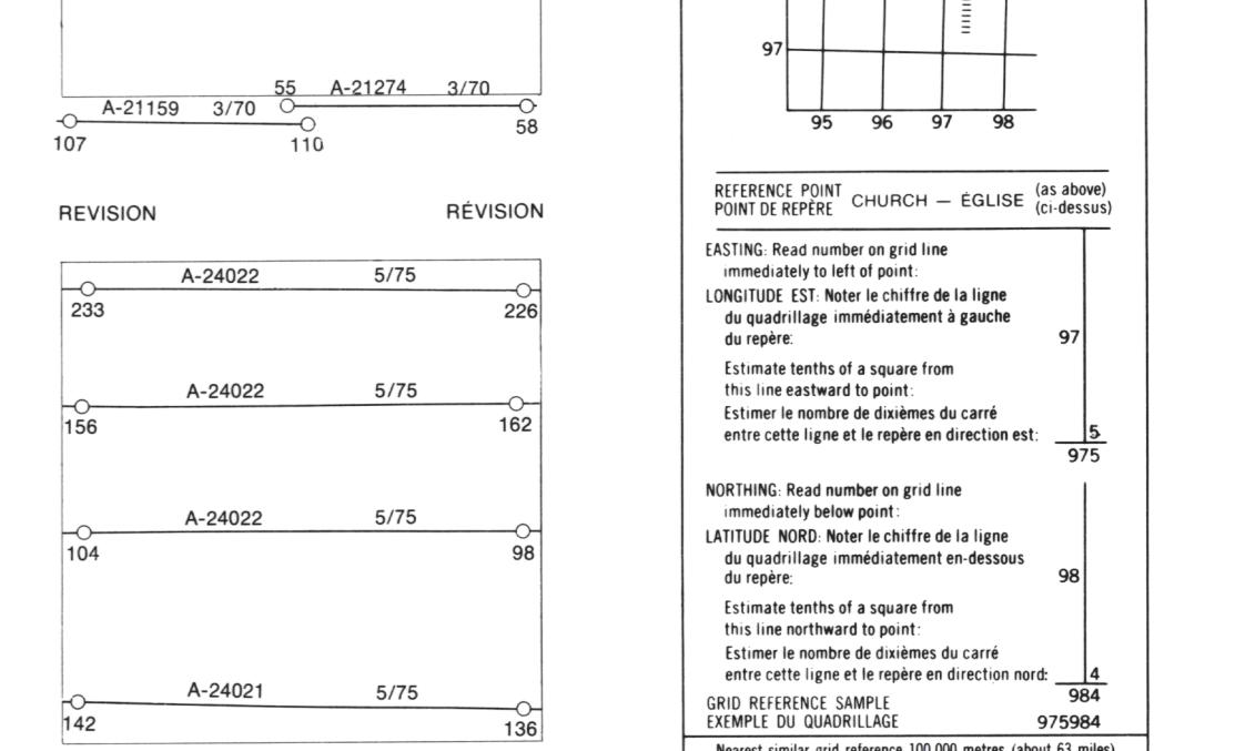
ONE THOUSAND METRE UNIVERSAL TRANSVERSE MERCATOR GRID ZONE 13 QUADRILLAGE DE MILLE MÈTRES UNIVERSEL TRANSVERSE DE MERCATOR
