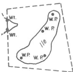
(f) Lorsqu'une étendue d'eau recouvre les quatre côtés d'un claim et que les poteaux témoins d'emplacement des coins sont à l'intérieur de ses limites, l'arpenteur doit calculer la position des coins en se basant sur les notes données au sujet des poteaux témoins. Si une limite quelconque entre coupe une île ou autre étendue de terre, des bornes témoins doivent y être posées.
