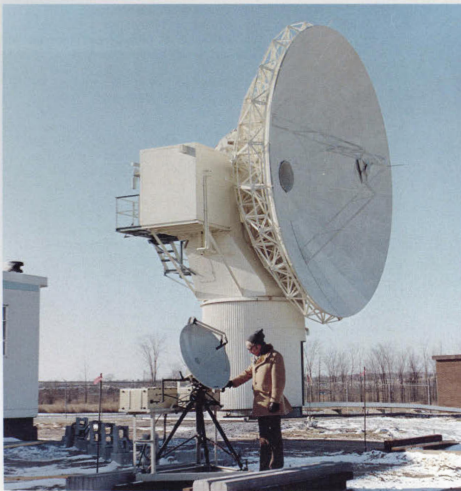
Vérification d'une station terrienne de 81 cm de diamètre, utilisée lors d'essais sur les communications directes par satellite.
