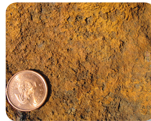
L'apparence piquée et terreuse de la roche reflète la présence de minéraux de sulfures de fer dans celle-ci. La pièce d'un cent indique l'échelle.
