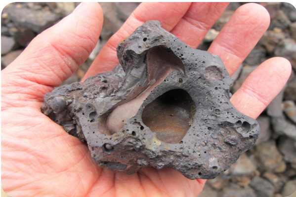
Vue 6 : Fragments de résidus présentant une texture de « fromage suisse » qui révèle leur origine dans un four de fonderie, où les bulles de gaz dans le laitier en fusion ont été emprisonnées à mesure que le laitier commençait à refroidir et à se solidifier. Les fragments de résidus concassés servent de remblai pour les plateformes routières et ferroviaires dans la région du Grand Sudbury.
