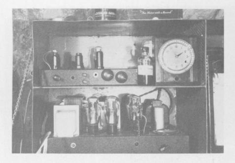
Fig. 24 Amplifier-Timer-Recorder: Mine Seismograph.
