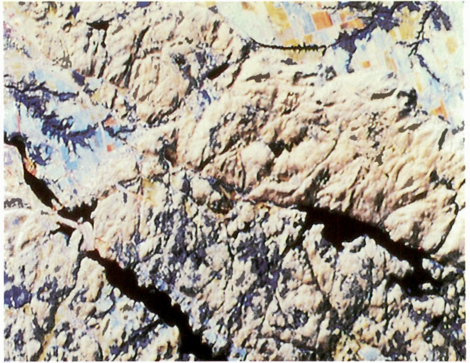
Accentuation d'une scène des collines de la Gatineau, au Québec, dans les bandes 4, 5 et 7 du balayeur multispectral. Les motifs structuraux révélant des failles et des fractures dans les roches du Bouclier canadien ressortent par rapport à la zone agricole plane des basses-terres du Saint-Laurent.
