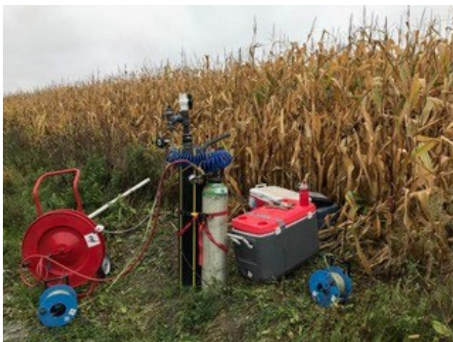
Figure 19 : Essai hydraulique à haute résolution dans un puits pour l'étalonnage de l'outil RMN dans le système d'esker de Vars-Winchester à Embrun, en Ontario.
