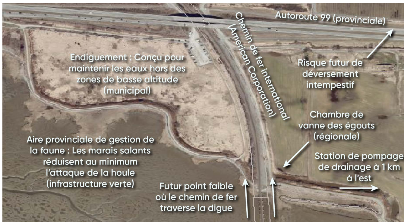
Figure 7.15 : Infrastructure interconnectée à Mud Bay, Surrey, C.-B., soulignant la nécessité d'approches coordonnées pour faire face aux risques présentés par l'élévation du niveau de la mer et d'autres dangers. Source : Adapté de la Ville de Surrey, 2018.
