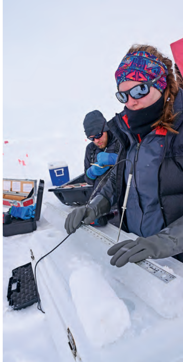
Mesure de la température d'une carotte de glace de mer de première année
