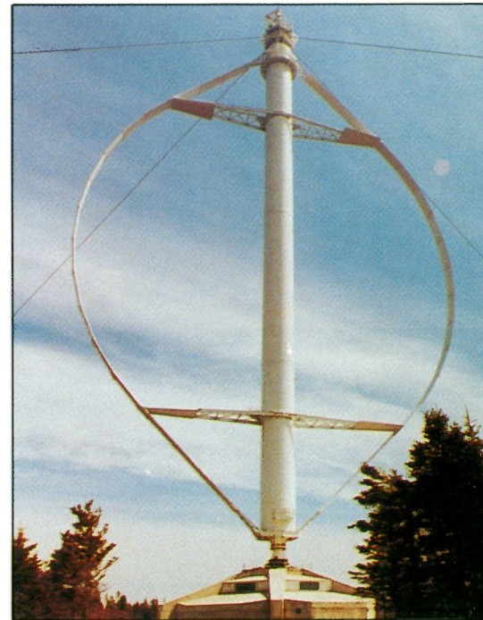
Éole, qui a une capacité de 4 mégawatts, est la plus grosse turbine éolienne à axe verticale au monde. Conçue et construite au Canada, elle est installée à Cap Chat, au Québec.
