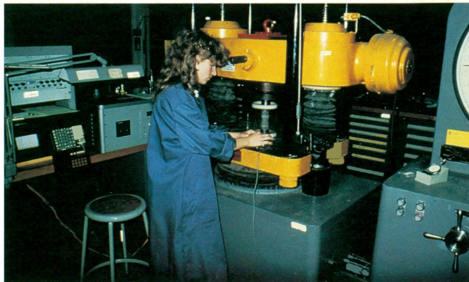
Figure 6 Essai de compression uniaxiale sur un échantillon de forage au Laboratoire de technologie minière d'Ottawa, et aménagement de la presse.
