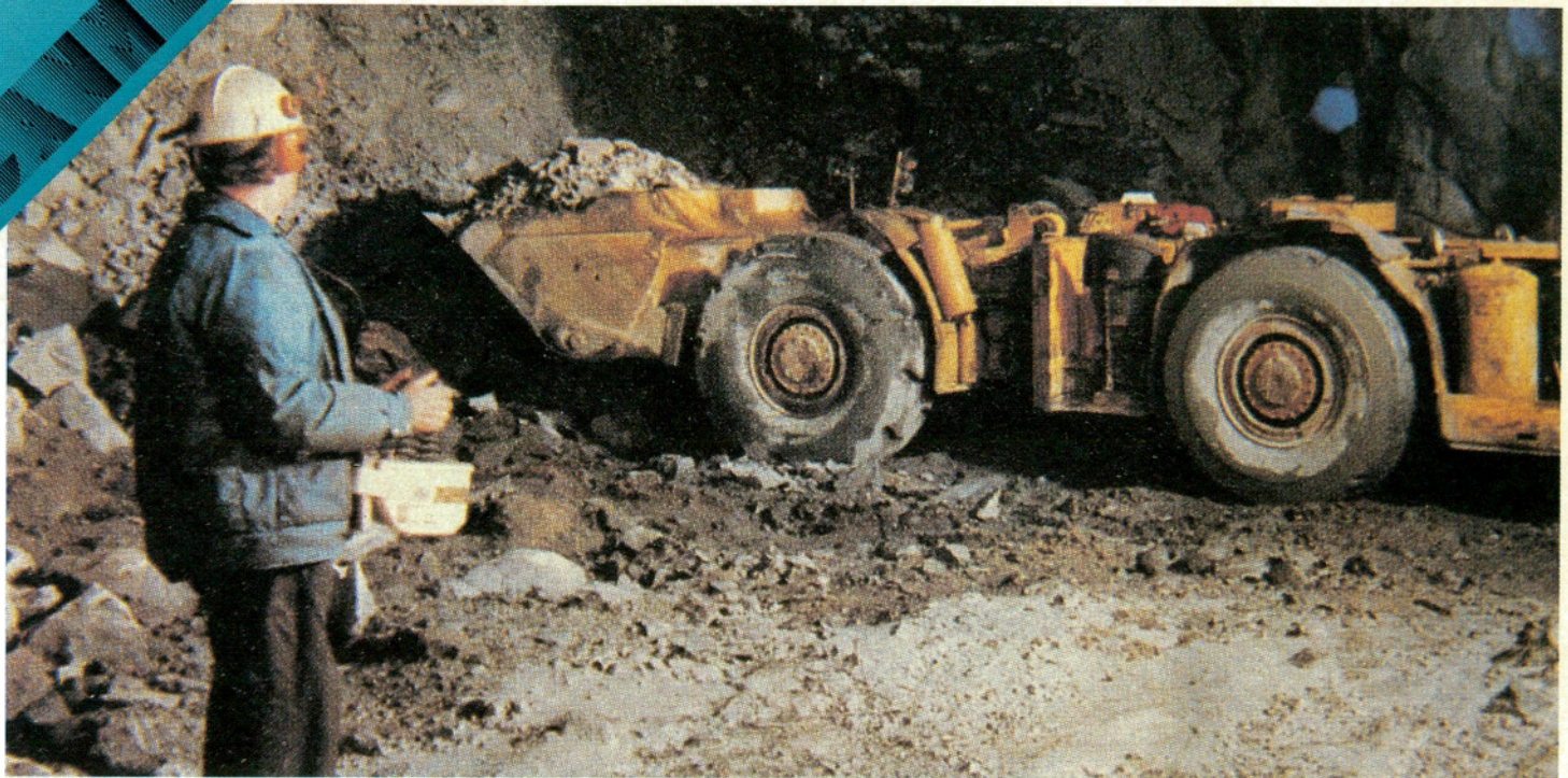
Figure 7 Télécommande d'une chargeuse-navette dans une mine souterraine.
