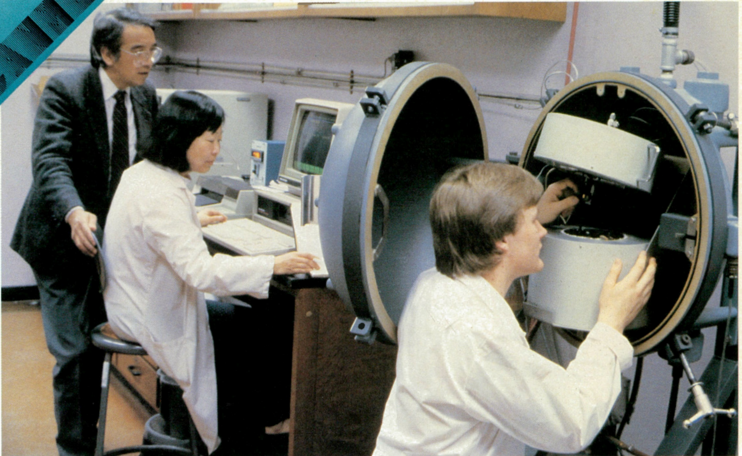
Figure 2 Chambre de mesures automatisées de la réaction exothermique des explosifs au Laboratoire canadien de recherche sur les explosifs d'Ottawa.
