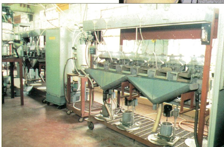
Une batterie de cellules de flottation équipée d'analyseurs à rayons X.
