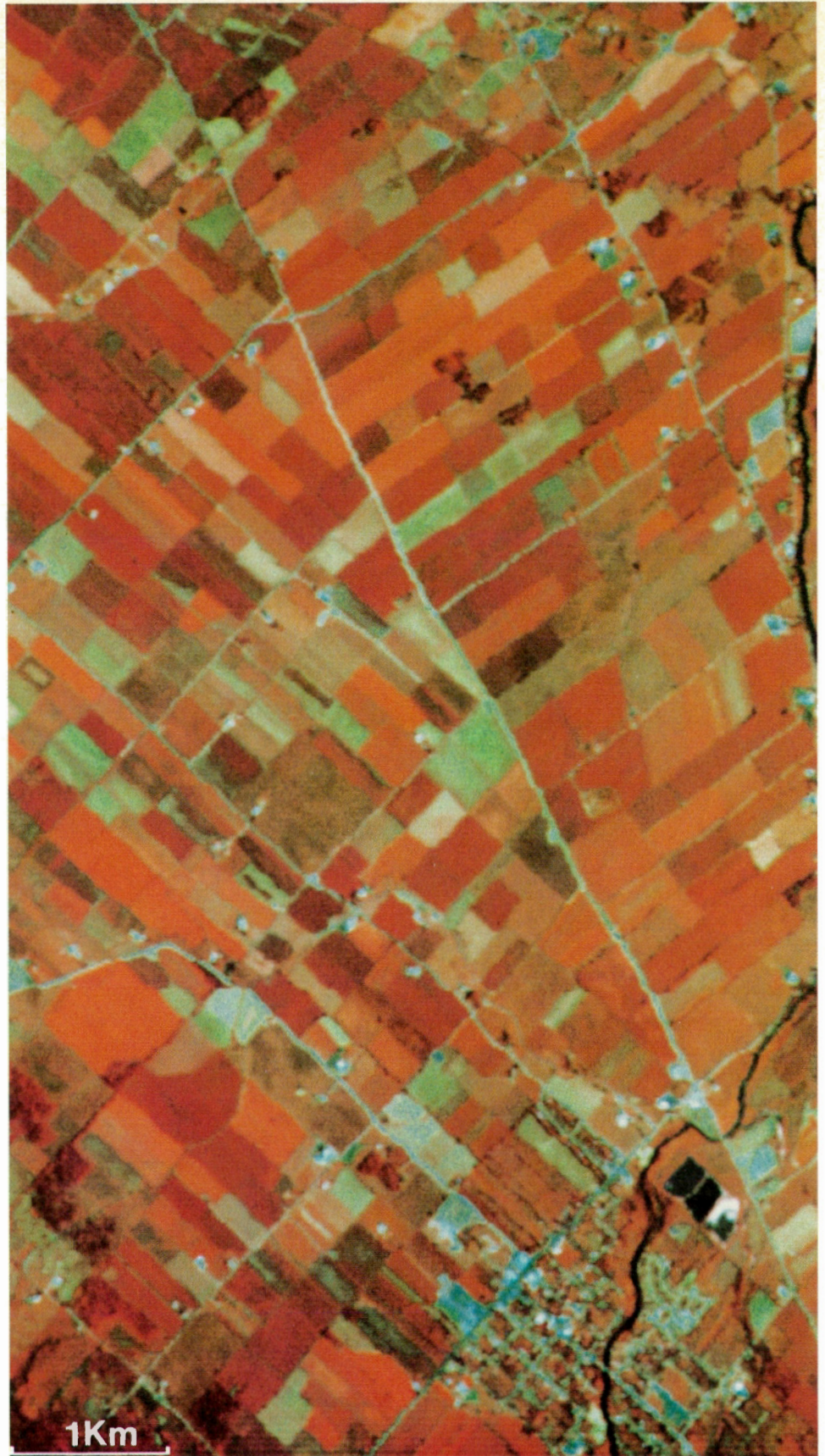
Figure 3 Simulation d'images SPOT sur la région de Richmond (Ont.); mode multispectral, pixel de 20 m. En brun-rouge: champs de maïs, en orange: céréales, en brun clair: champs de foin, en bleu: surfaces de sol nu et chemins bitumineux
