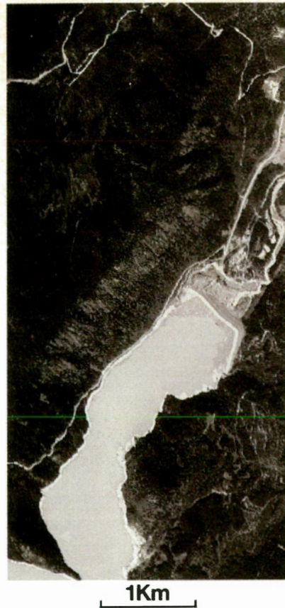
Figure 2 Simulation d'images SPOT sur le site de Gun Lake (C.-B.); mode panchromatique, pixel de 10 m à gauche; mode multispectral, pixel de 20 m à droite
