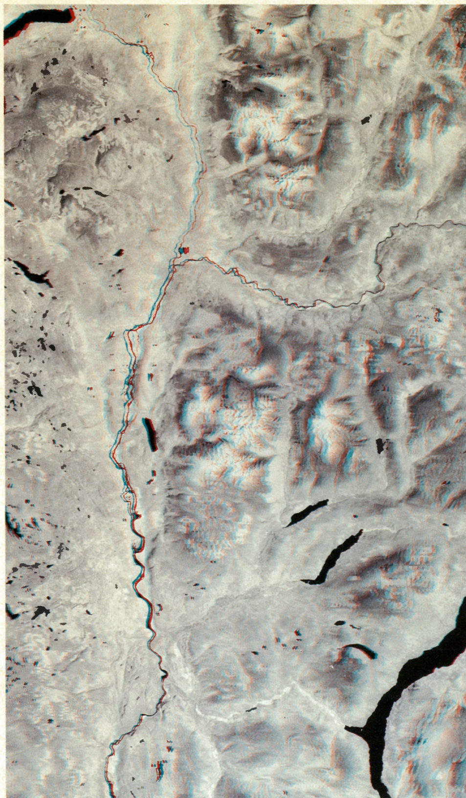
Figure 6 Anaglyphe représentant une région des montagnes Rocheuses ayant subi une accentuation numérique afin d'accroître l'effet de relief. Le modèle numérique de terrain a été obtenu à partir d'images stéréoscopiques du LANDSAT-2 (par recouvrement latéral grâce au pincement des orbites dans les régions nordiques).
