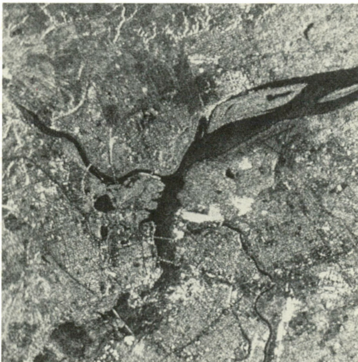
a. Image combinée SEASAT/LANDSAT de la région d'Ottawa. L'intensité des images en noir et blanc fournies par le radar à ouverture synthétique (SAR) de SEASAT permet de réaliser, par modulation numérique, le coloriage des images obtenues de LANDSAT. b. Image des bandes 4, 5 et 7 fournie par le balayeur multispectral MSS de LANDSAT le 6 juin 1978.
