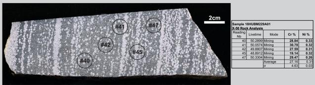
Figure 7. Chromite litée de la Zone Chromifère III. Analyses obtenues avec l'analyseur XRF portable Innov-X System X-50.
