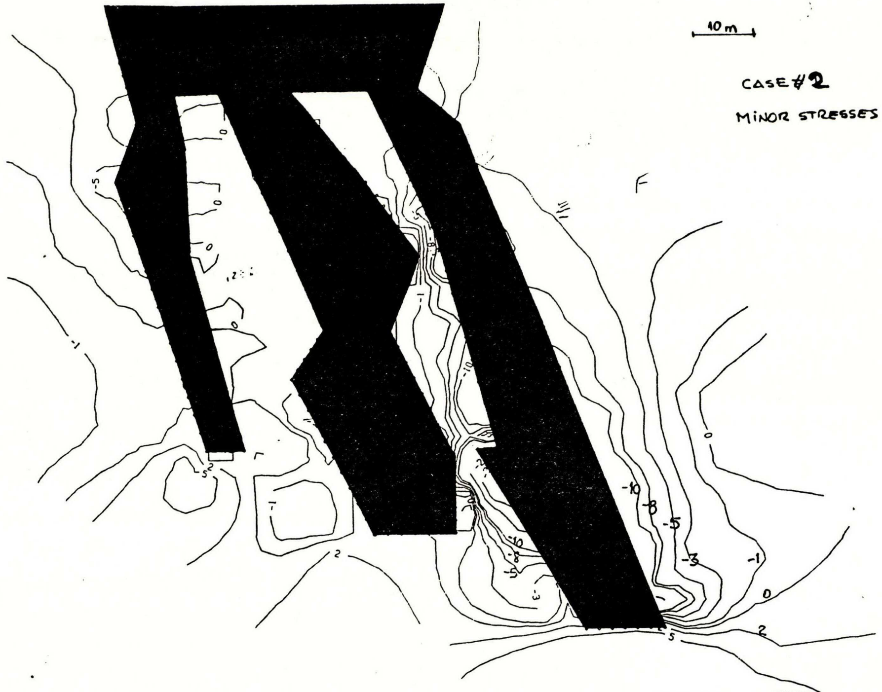
Figure 20(d). Application du programme BITEM à la mine Ruttan. Modélisation de la fosse & ouvertures
