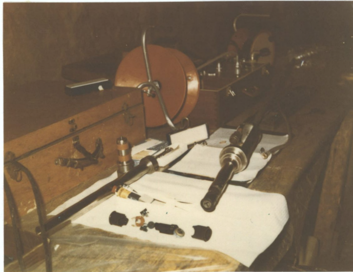
Fig. 1 - Outils pour les mesures de contraintes.
