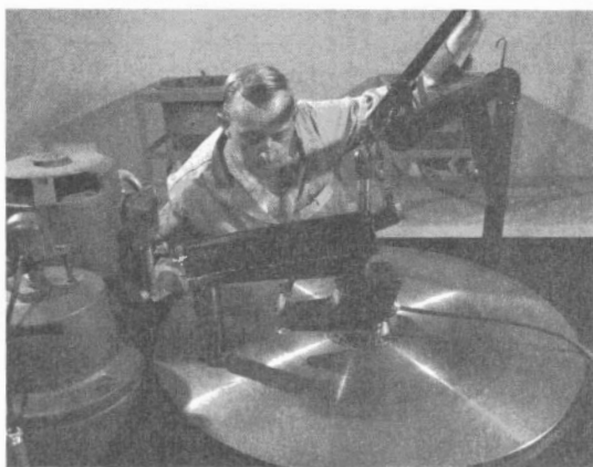
M. Blais règle l'appareil de choc sur les roches construit par la Division des services techniques (Photo - George Hunter)
