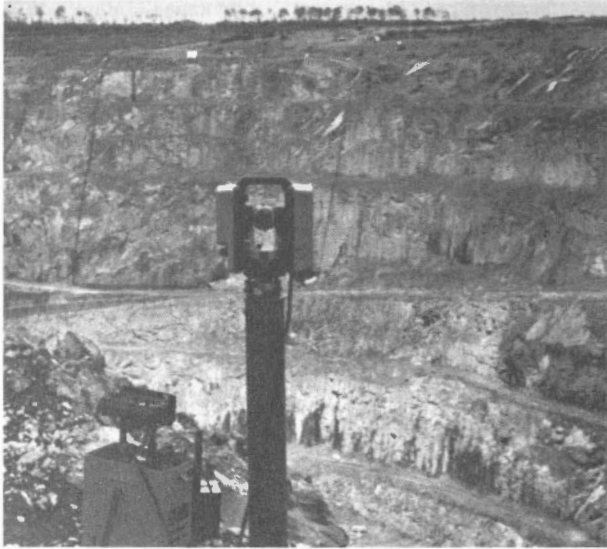
Théodolite laser monté sur base type CGC à la mine Kidd Creek. Sert à mesurer angles et distance pour surveiller les mouvements des sols.
