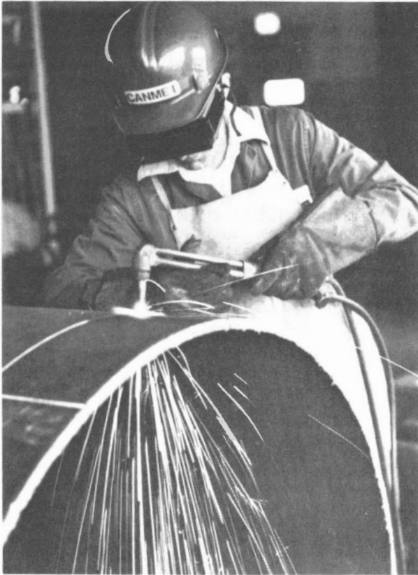
M. Letts découpe un échantillon dans un tuyau à gaz commercial de grand diamètre.
