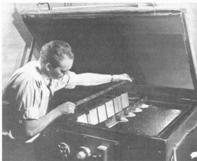
W. Dingley inspectant des échantillons au cours d'un essai précédent de corrosion marine accélérée (Photo (ONF)
