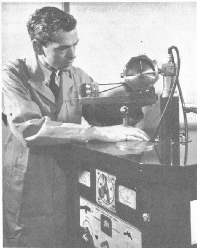
C.M. Mitchell utilise un appareil à diffraction de rayons X acquis au début des années 50 (Photo - ONF)
