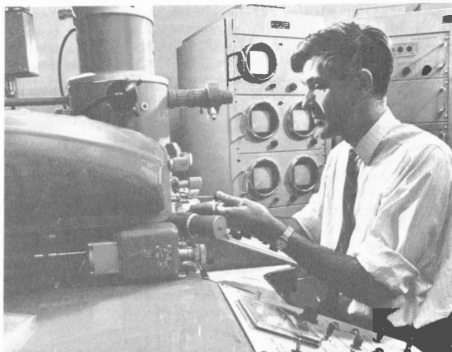
H. Thresh utilisant le premier microanalyseur à sonde électronique installé aux LRMP en 1964. L'instrument permet d'identifier les composés dispersés dans un alliage (Photo - George Hunter)
