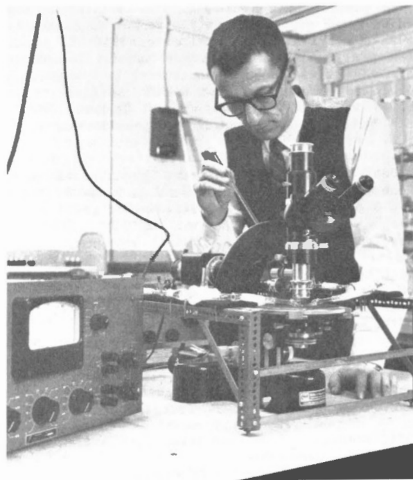
L. Sirois détermine les caractéristiques électriques des minéraux dans le cadre de la recherche sur la flottation (Étude de l'électrophorèse) (Photo - George Hunter)
