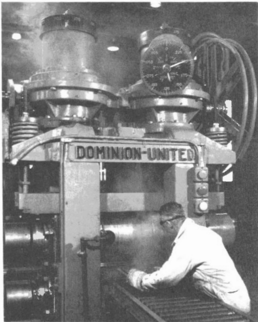
A. Baker ajuste une plaque de magnésium pendant une opération de laminage
