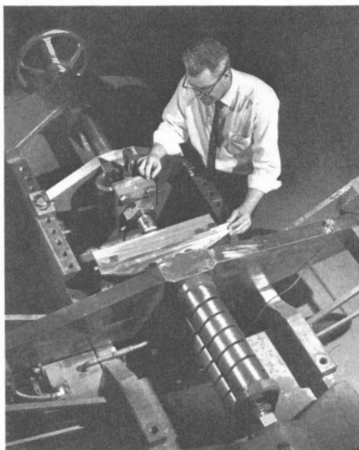
J.A. Ellis effectue des essais de fatigue sur un échantillon métallique (Photo - George Hunter)
