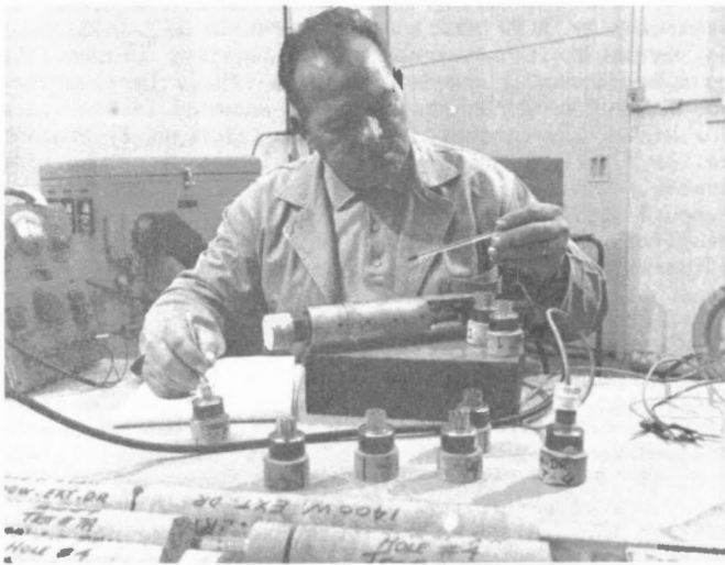
J. St-Onge effectue des mesures au laboratoire après les études de terrain sur les contraintes; on voit les jauges de contrainte Leeman en butée de porte.
