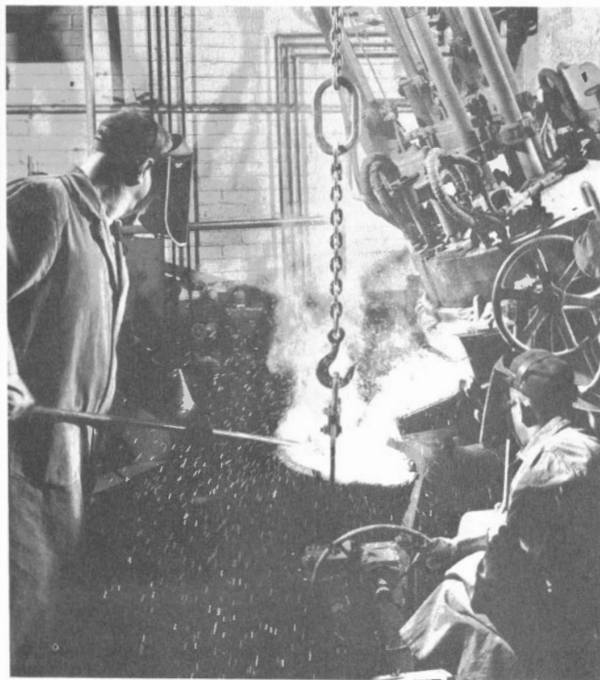
E. Cere et A. Lévesque déversant l'acier fondu du four à arc électrique de 600 livres (Photo - George Hunter)
