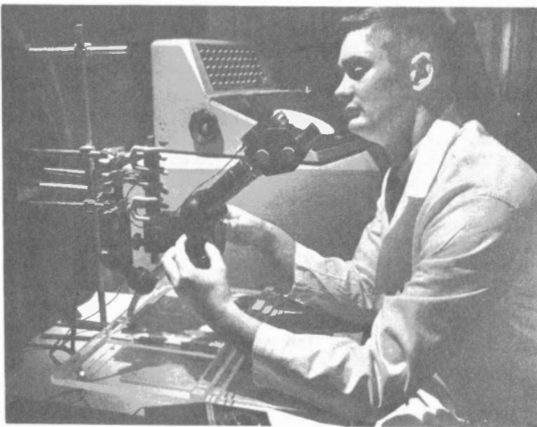
F. Barton mesurant la distribution de longueur des fibres d'amiante (Photo - George Hunter)
