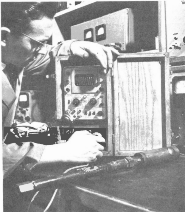
F. Kapeller réglant l'instrument de mesure de la vitesse du son dans les roches.
