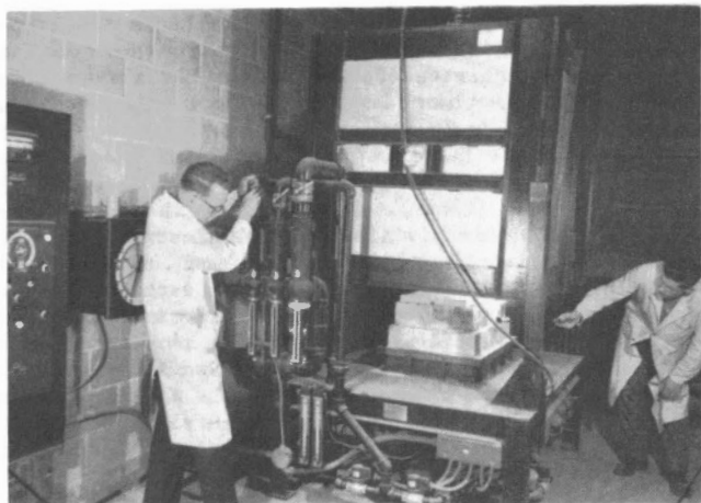
H. Mercier effectuant la cuisson de briques dans le four Remney (températures atteignant 3500°F)
