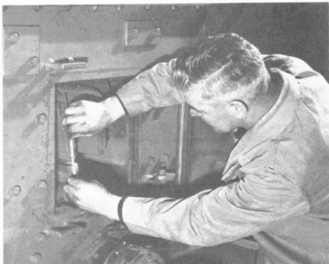
A. Boissonnault règle le broyeur à impact avant traitement d'un minerai de fer du nord de l'Ontario
