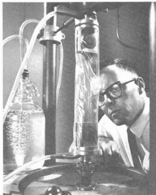
E.G. Eeles mesure l'effet de l'humidité sur les propriétés de fatigue d'un alliage d'aluminium (Photo - George Hunter)
