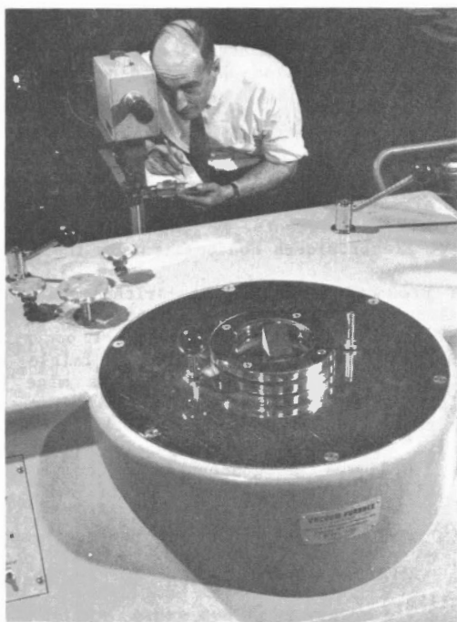
A.J. Williams effectue un traitement thermique sous vide d'un alliage au niobium à haute résistance (Photo - George Hunter)
