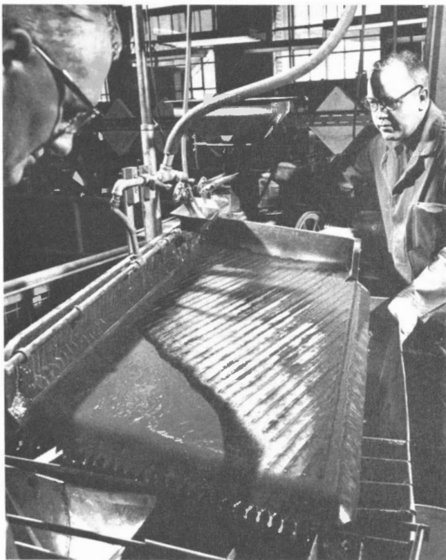
H. Renaud et R. Bruce effectuent un essai de concentration par gravité.
