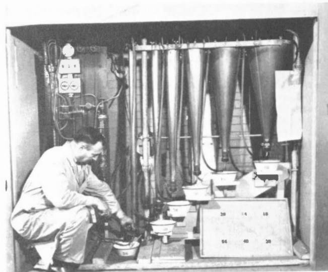
H.R. Renaud effectue l'analyse de taille d'échantillons de minerais au Haultain Infracizer, 1960 env.
