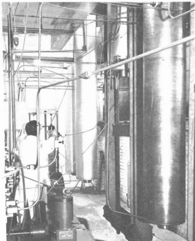
Vases de pression conçus à l'origine pour l'hydrogénation en phase vapeur à 20000 psi, rue Booth.
