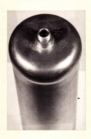
CYLINDER DISCHARGE VALVE JOINED TO STEEL SHELL BY WHAT APPEARS TO BE A SILVER BRAZE.
