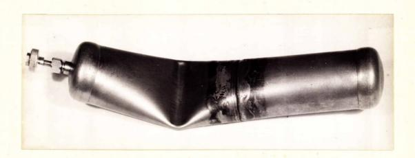
APPEARANCE OF CYLINDER AFTER FLATTENING TEST.
