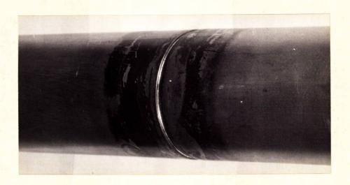
GLOSE-UP OF JOINT JOINING THE TWO HALVES OF THE SHELL.
