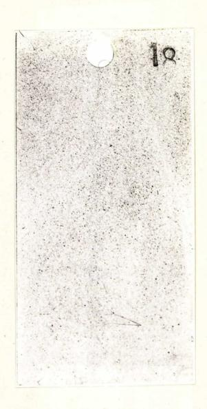
STEEL PANEL AFTER HYDROBROMTC ACID NEUTRALIZATION TEST IN WHICH THE EMULSION CONTAINED MCCOLL-FRONTENAC LUB. OIL AND THE NEUTRALIZING MIXTURE CONTAINED MCCOLL-FRONTENAC PREVENTIVE COMPOUND AND LUB. OIL.
