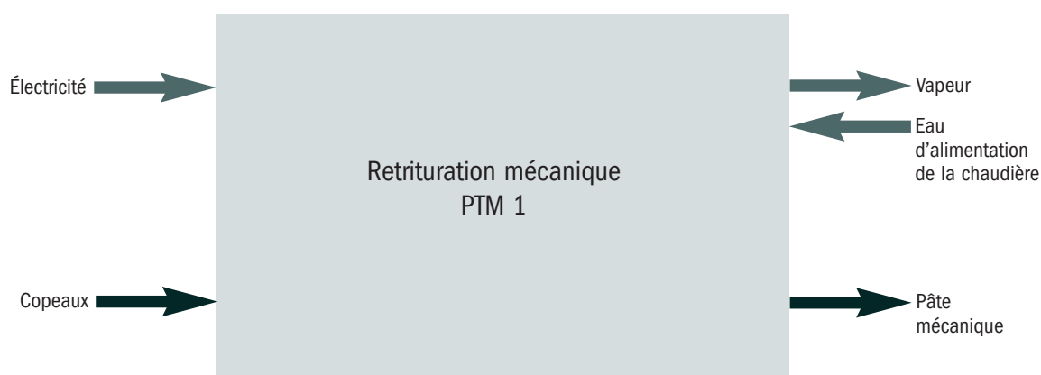
Figure 2-2 Intrants et extrants d'énergie et de fibre d'une zone de mise en pâte mécanique
