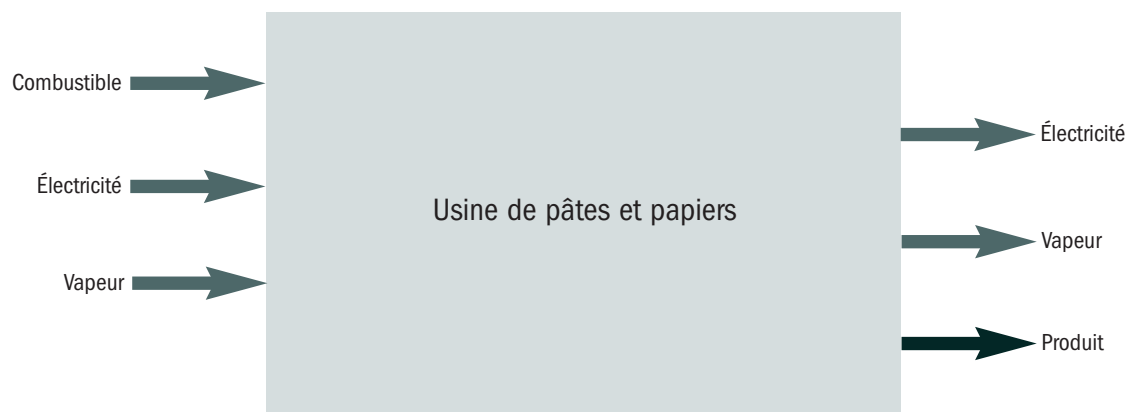
Figure 1-1 Intrants et extrants énergétiques d'une usine de pâtes et papiers
