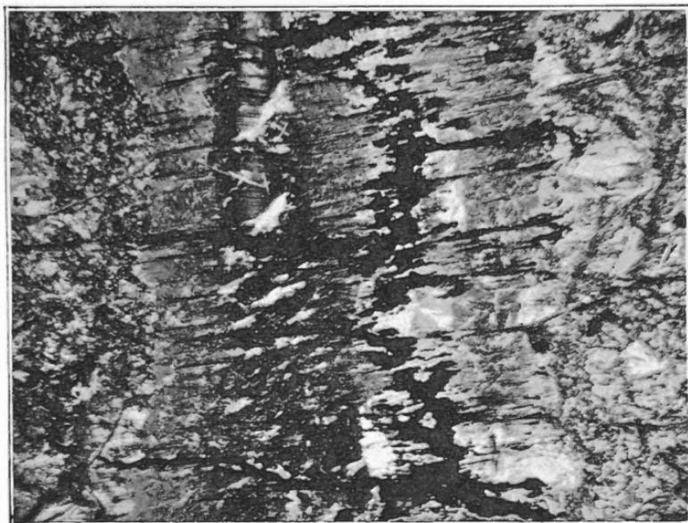
Photomicrographie d'une veine d'amiante montrant la nature irrégulière de la feuille de magnétite et le contact de la veine avec la serpentine encaissante. X 14; nicols croisés.
