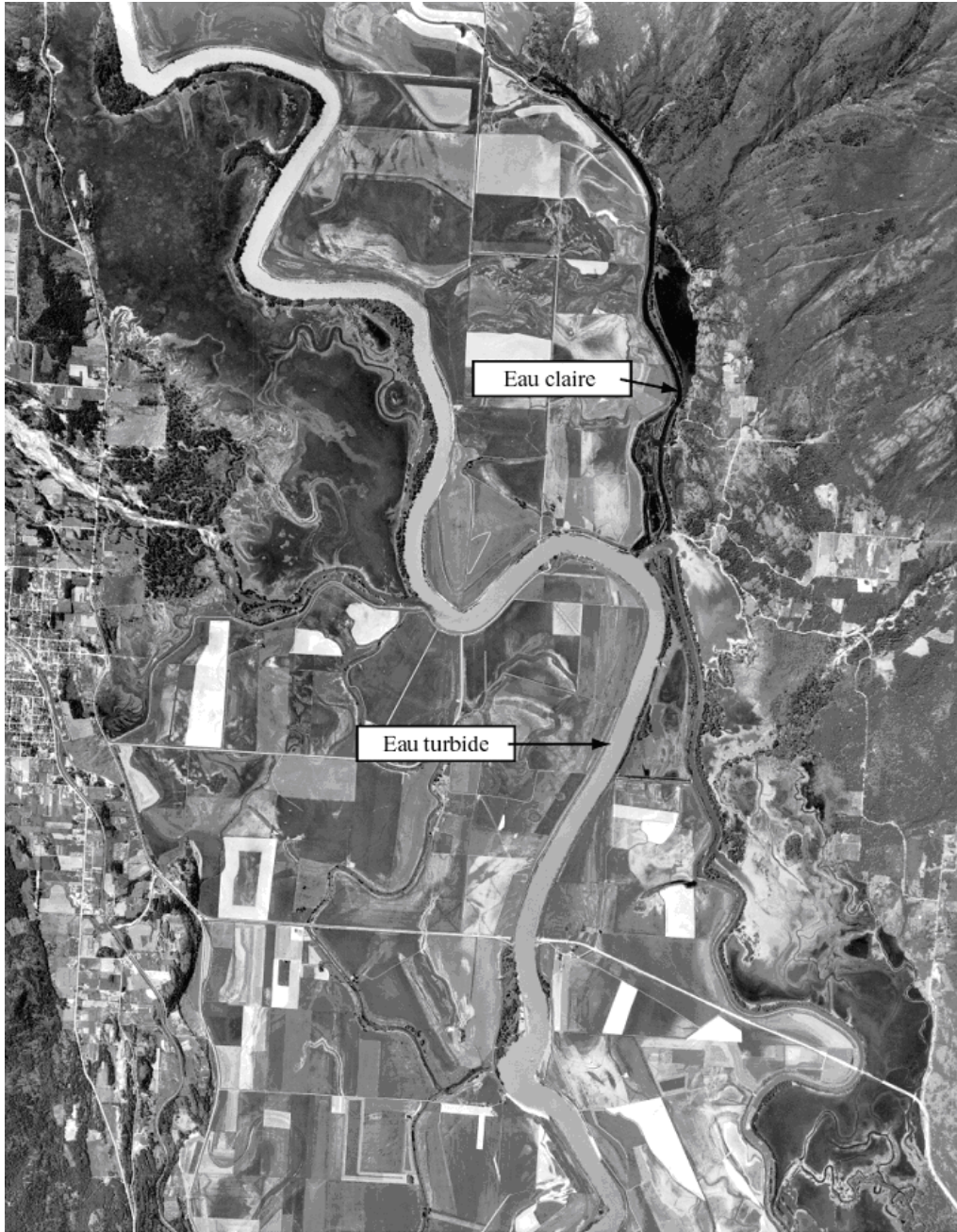
Figure 13 : Exemple d'un cours d'eau entièrement affecté par la turbidité avec un affluent d'eau claire.
