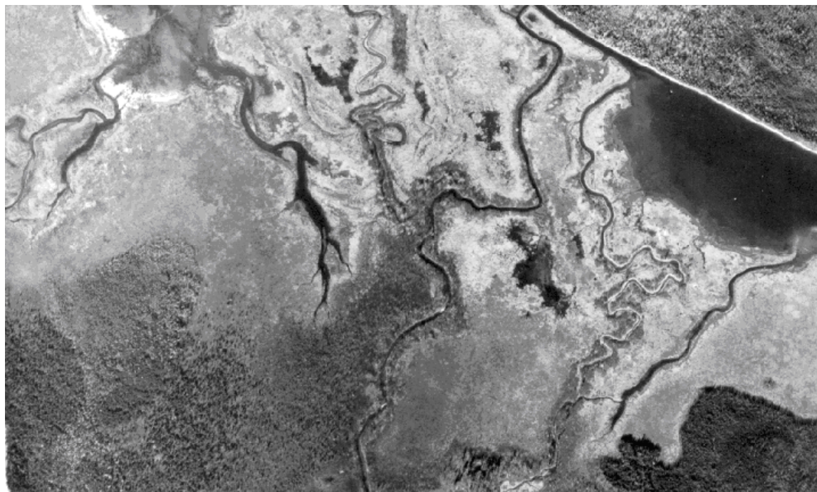
Figure 17c : Exemple de variation de niveau d'eau dans un plan d'eau : bas niveau (394,0 m) engendrant une sous-estimation de la limite de l'eau permanente
