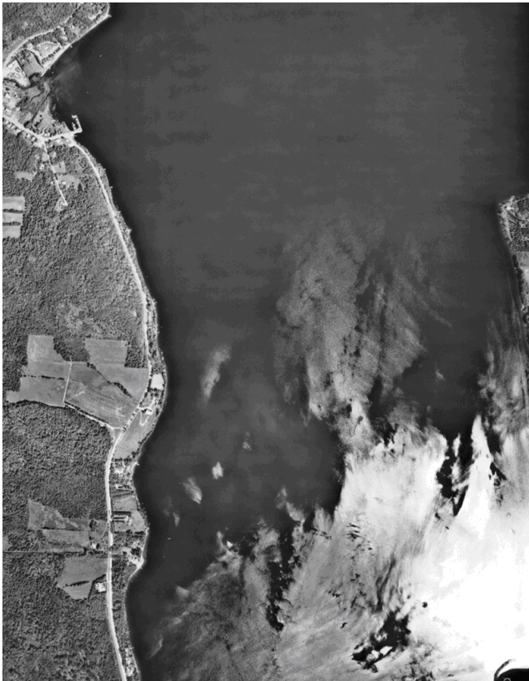
Figure 24 : Exemple de réflexion spéculaire sur une partie d'un plan d'eau
