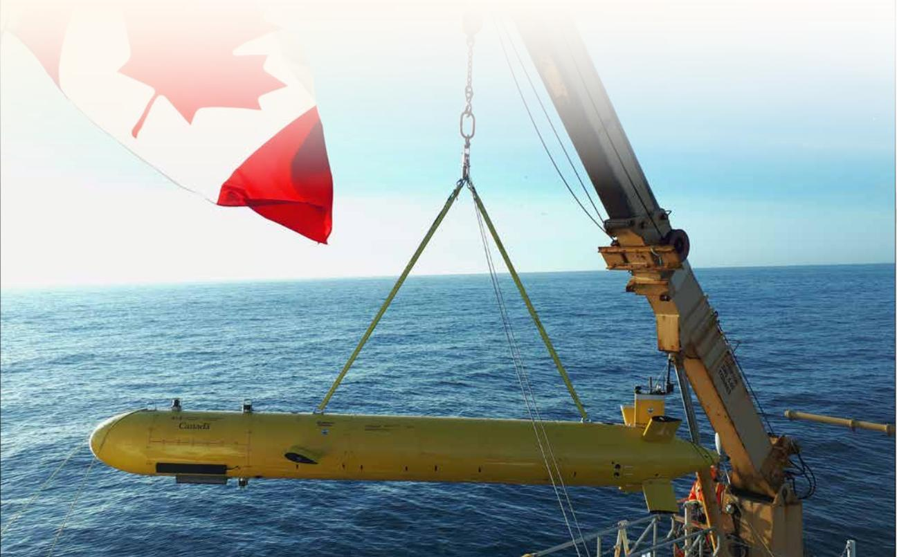
Déploiement d'un véhicule sous-marin autonome (VSA) dans le cadre d'un projet réalisé en collaboration avec le gouvernement de la Nouvelle-Écosse dans le but de cartographier les suintements naturels possibles de pétrole et de gaz sur le fond marin à plus de 2 000 mètres de profondeur au large de la Nouvelle-Écosse.
