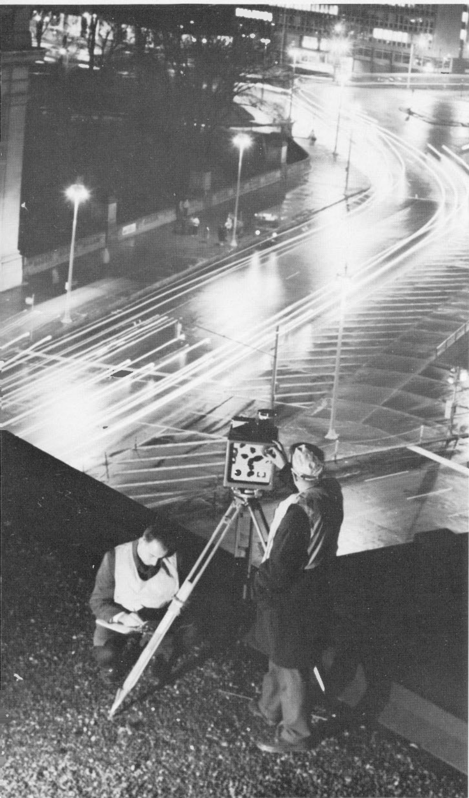
Les spécialistes des Levés topographiques utilisent des instruments modernes de mesurage électronique. Un géodimètre placé au sommet d'un bâtiment scrute, la nuit, la circulation dense, en vue d'en faire un relevé municipal.
