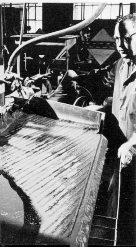
Le minerai de tungstène concentré est déposé sur un appareil d'essai utilisé pour la séparation par gravité de minéraux lourds tels que l'étain, le tungstène, la galène, l'argent, l'or et le niobium. (George Hunter #13766)
