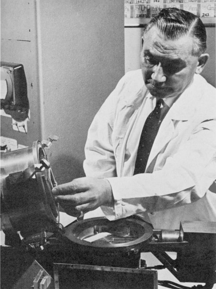
Homme de science de la Direction des mines se préparant à étudier un échantillon de minerai à l'aide du micro-analyseur électronique, afin de déterminer la nature et la teneur des éléments présents au sein de la microstructure. (George Hunter #13740)
