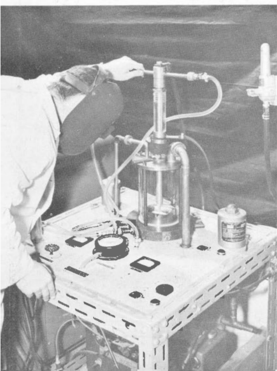
Appareil de fusion à l'arc, sous vide, en milieu inerte; il est utilisé par la Direction des mines dans l'élaboration de nouveaux alliages destinés aux applications de l'énergie nucléaire.
