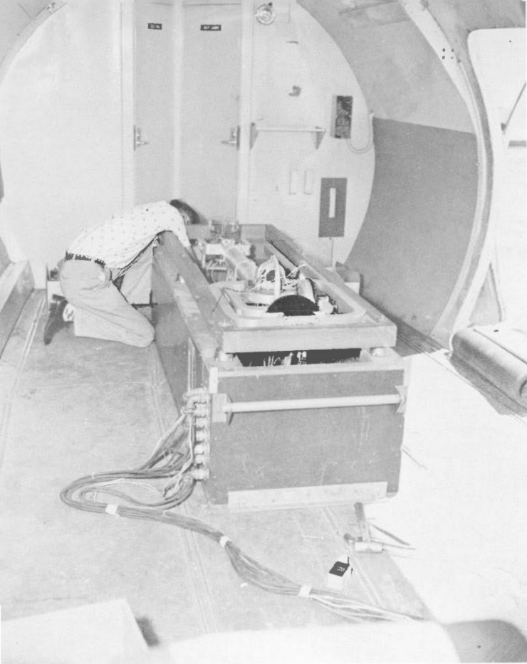
En 1960, le magnétomètre aéroporté de l'Observatoire fédéral, qui mesure et enregistre la déclinaison magnétique (variation du compas) ainsi que l'intensité horizontale et verticale du champ magnétique, a parcouru une distance de 45,000 milles. Cet instrument a été installé à bord d'un avion nolisé de type DC-4.
