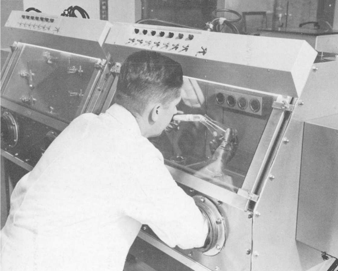
La «boîte à sec» de la Direction des mines permet d'effectuer des travaux, sur des matières hautement réactives, en atmosphères contrôlées (azote, argon ou air parfaitement sec).
