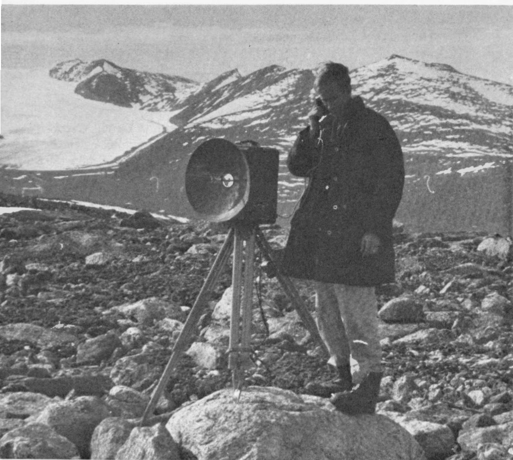
Le telluromètre, appareil électronique de très haute précision servant à mesurer les distances, a été utilisé par la Division des levés topographiques lors de travaux aériens et dans la plupart de ses chemements. Voici un telluromètre prêt à fonctionner (côte sud de l'île Baffin).
