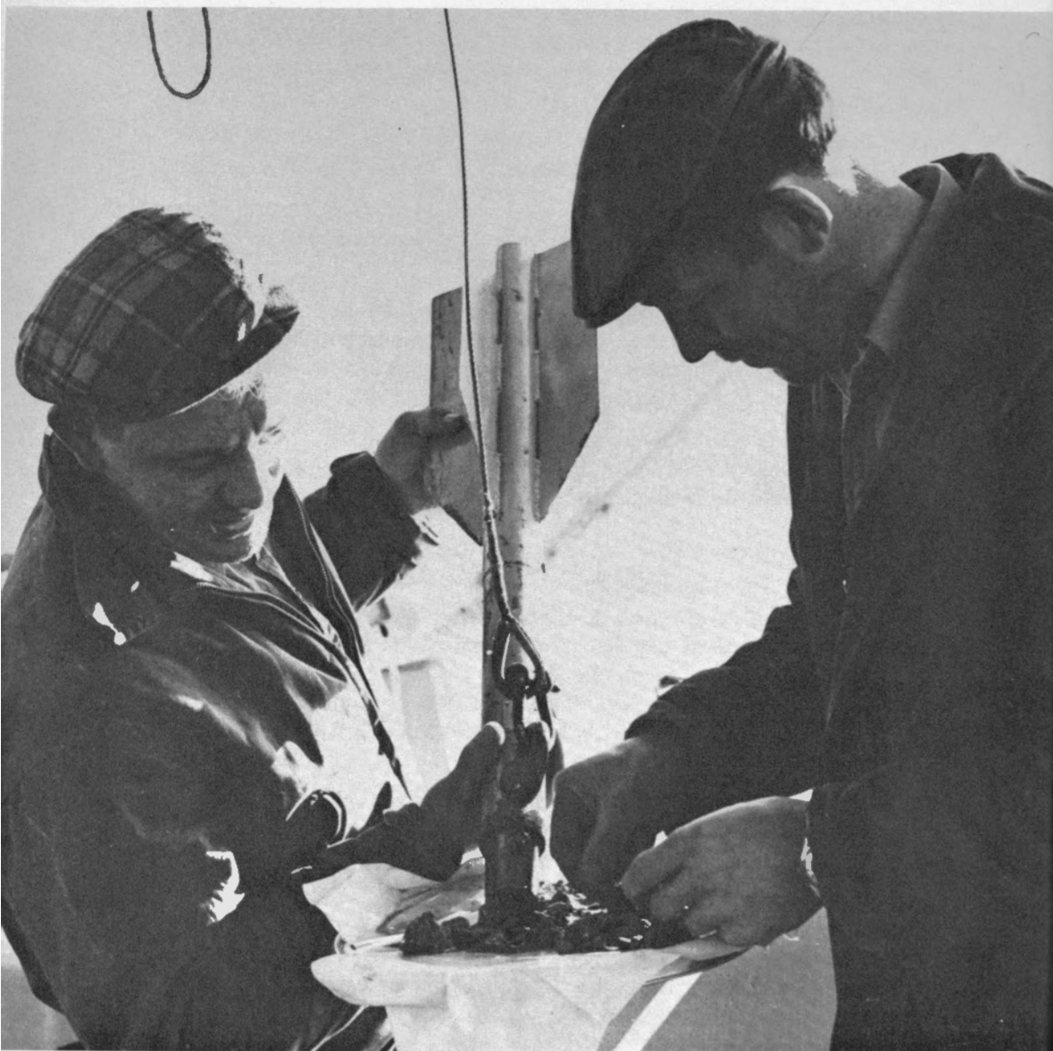
Des hydrographes à bord du Baffin examinent un échantillon de sédiments prélevé sur le fond de la mer à l'aide de l'échantillonneuse spécialement utilisée à cette fin. En raison de son poids, ce lourd appareil tubulaire peut être descendu sous l'eau même lorsque le vaisseau file à une vitesse de 13 noeuds.
