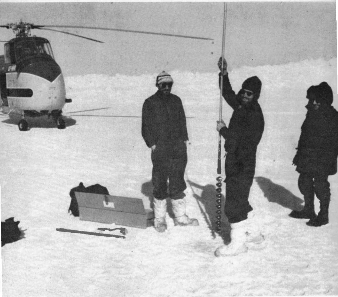
Hydrographes en train de forer un trou dans la glace du plateau continental polaire, afin d'effectuer des sondages en profondeur (nord de l'île Ellef Ringnes).
