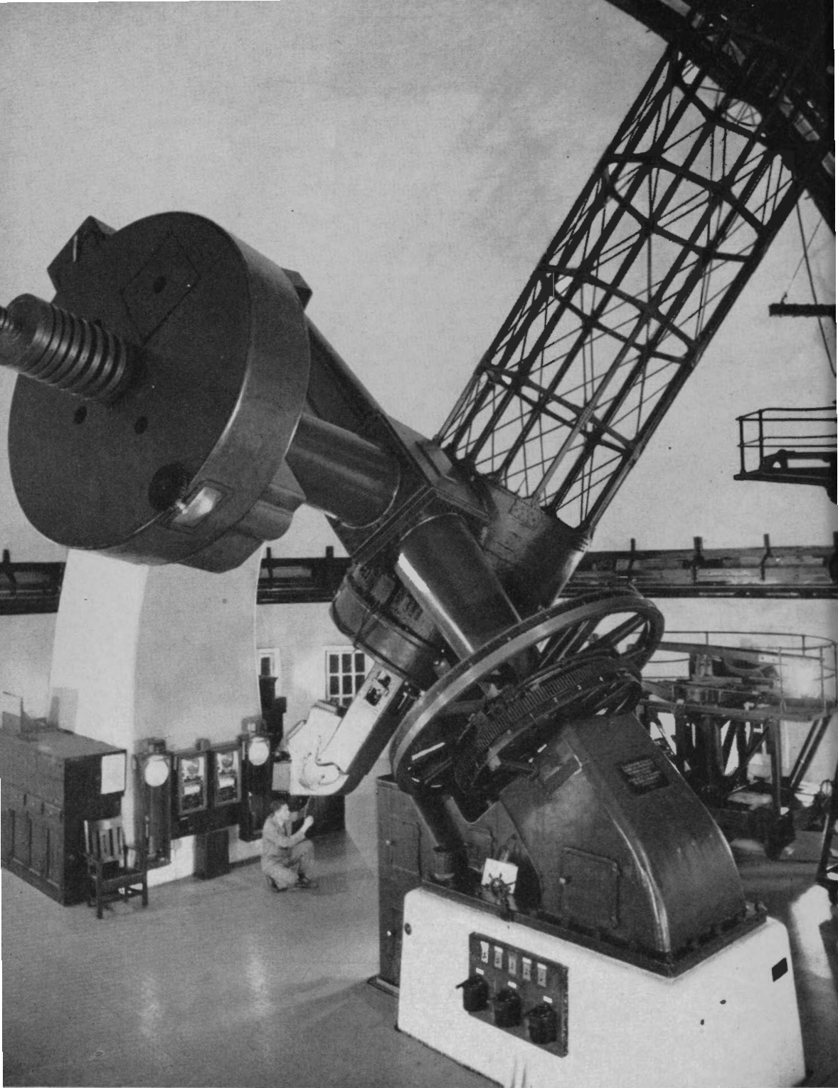
Télescope à miroir, de 73 pouces, l'un des plus grands au monde, et qui se trouve à l'Observatoire fédéral d'astrophysique de Victoria (Colombie-Britannique). Le miroir primaire est au bas de la cage; au centre de celle-ci, près de l'extrémité supérieure, on voit le miroir secondaire, de 20 pouces. La photo montre les deux axes, sur lesquels sont calés des cercles gradués, où l'on reporte les deux coordonnées des astres. Le spectrographe s'allonge au-dessous de la loge du miroir, au bas de la cage. Remarquer, à droite, la plate-forme monte-et-baisse qui permet d'accéder à l'extrémité supérieure de la cage.
