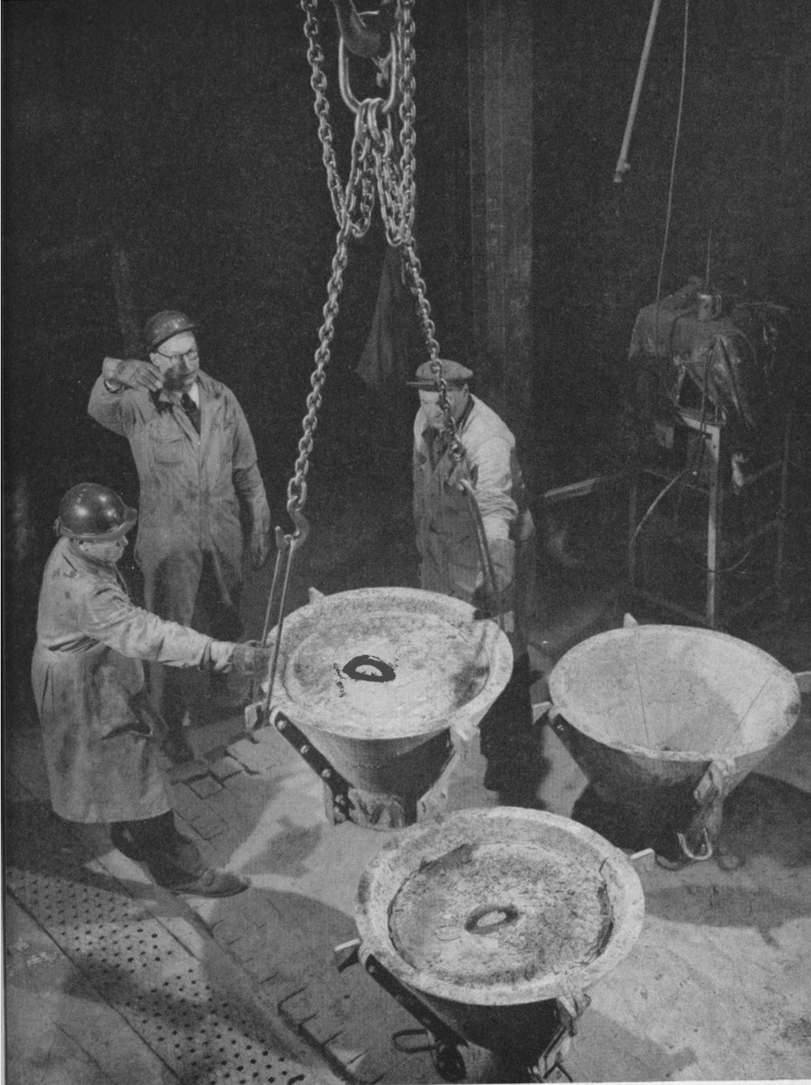
Matte sortant d'un four électrique de 250 kilowatts-ampères, au cours d'une étude approfondie faite, dans une installation d'essai, sur un minéral complexe de nickel.
