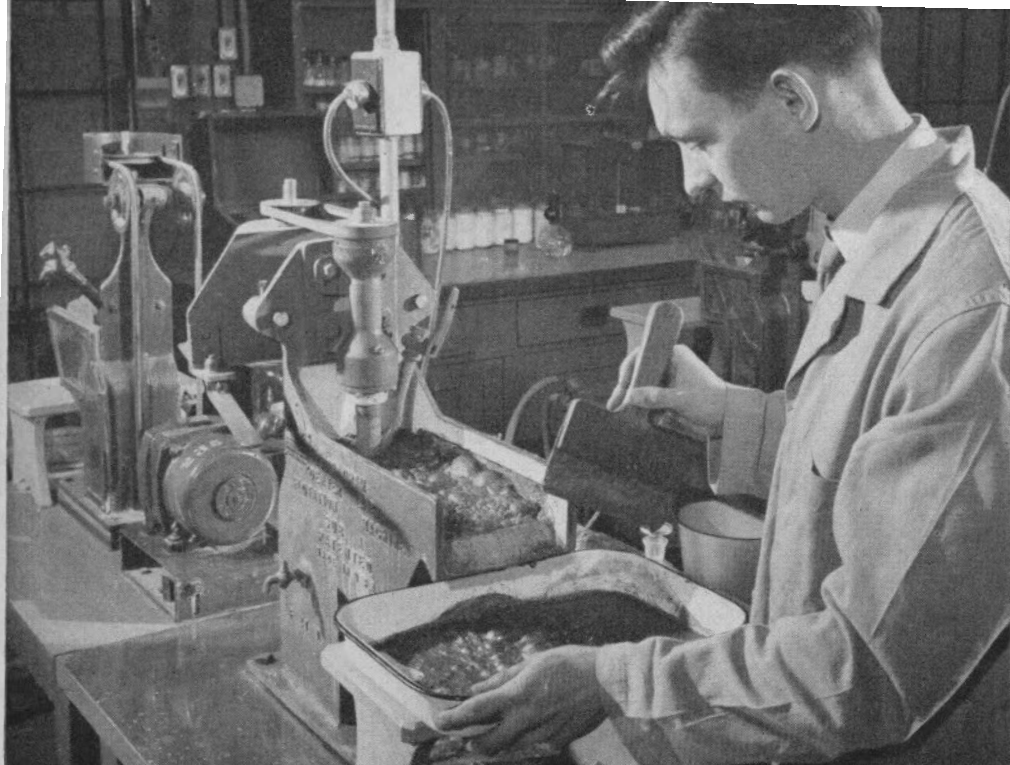
Bac de flottation, à l'échelle d'un laboratoire, utilisé pour l'essai des minerais par charge.
