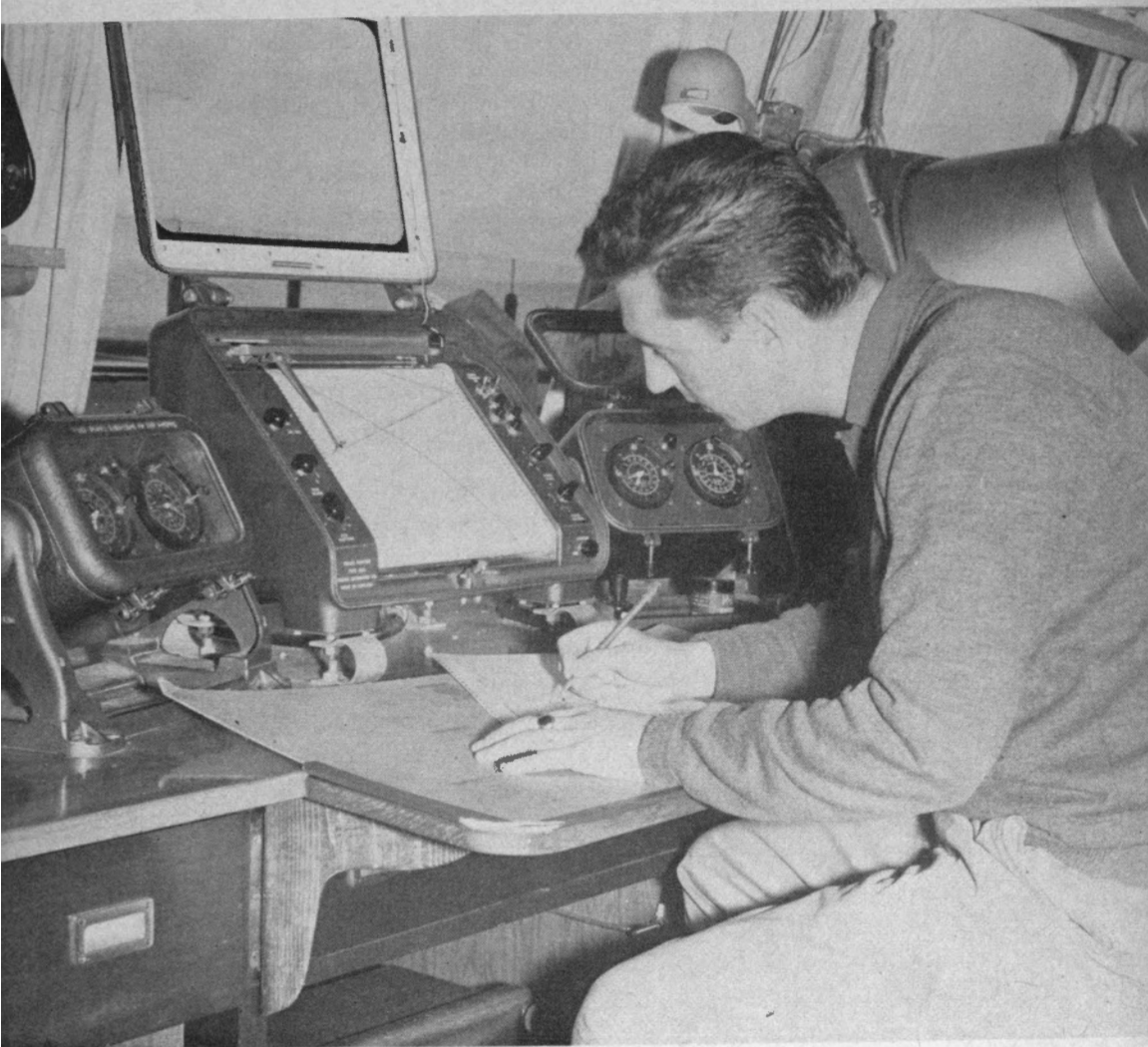
Hydrographe à bord du Baffin , relevant la position du navire qu'indique le tableau spécial du decca, système de radionavigation à deux courbes de réseau d'hyperboles. Les lectures du décomètre donnent la position exacte du navire et le loch en détermine continuellement la direction.
