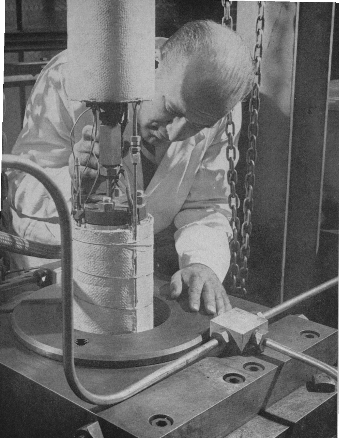
En cherchant des procédés satisfaisants et pratiques de raffiner les pétroles pauvres et le bitume, les techniciens se servent d'une usine-pilote d'hydrogénation. On voit ici la chambre de réaction, chauffée à l'électricité et isolée, de l'atelier, qu'un technicien introduit dans un vase clos.
