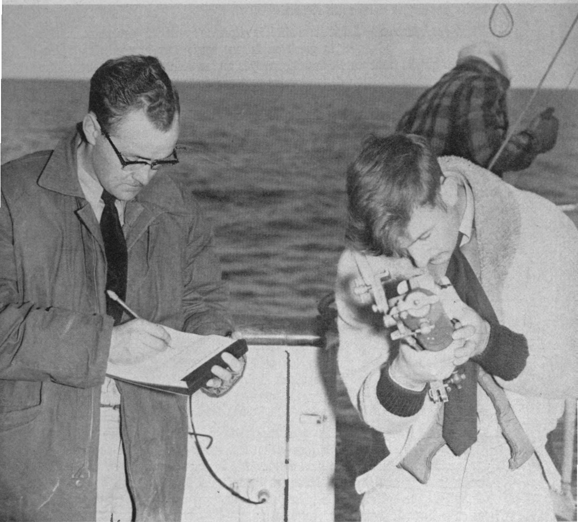
Lecture d'un thermomètre réversible pour profondeurs marines, après le relèvement d'un point océanographique. Cette opération consiste à déterminer la température de l'eau et à prélever un échantillon d'eau salée à des profondeurs de 10, 20, 30, 50, 75 et 100 mètres.
