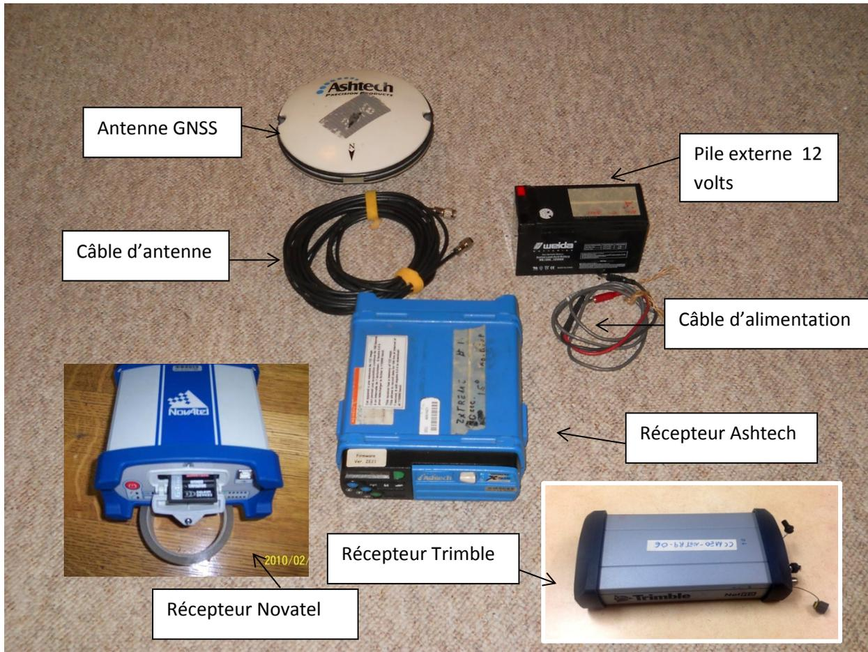
Figure 6. Récepteurs GNSS et leurs composants.
