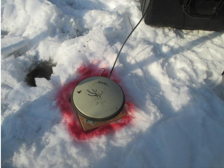
Figure 8. Antenne GPS déposée directement sur le sol.
