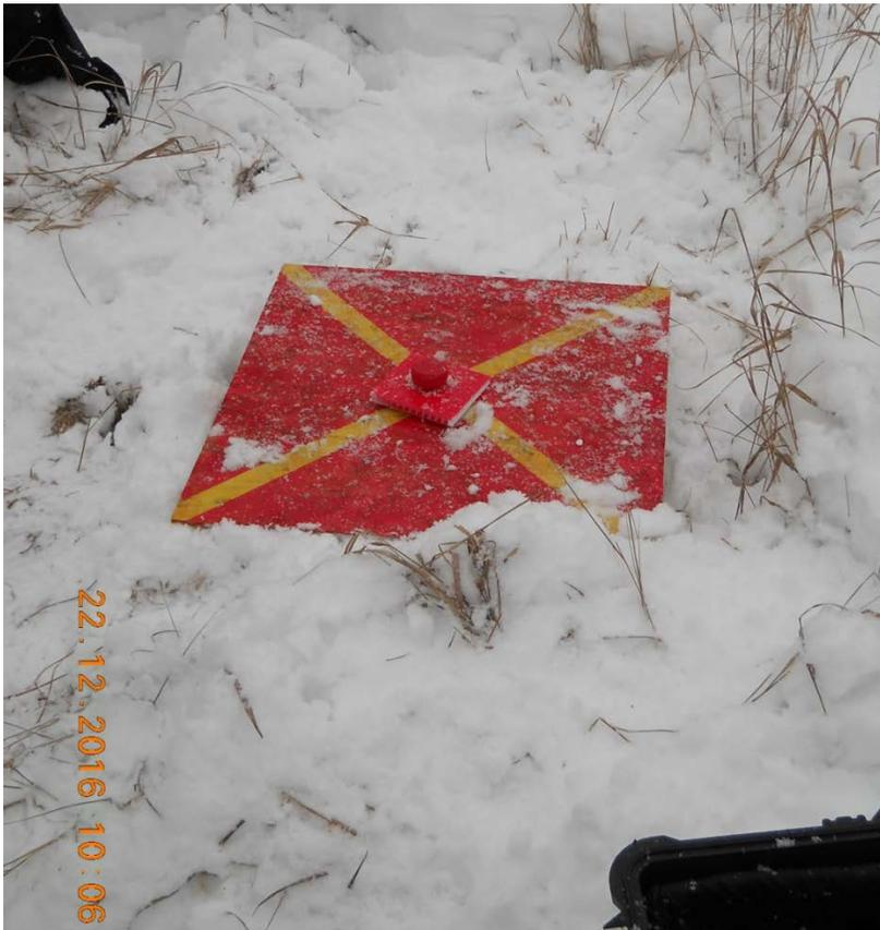
Figure 7. Exemple de cible de référence pour un survol par ASP.
