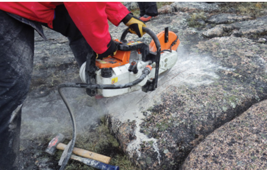
On utilise une scie à béton/roche pour sélectionner un échantillon de substratum à l'ouest de Wager Bay, au Nunavut.
