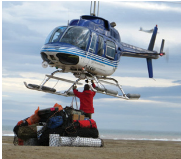
On attache une charge à l'élingue à un hélicoptère sur Banks Island, dans les Territoires du Nord-Ouest.
