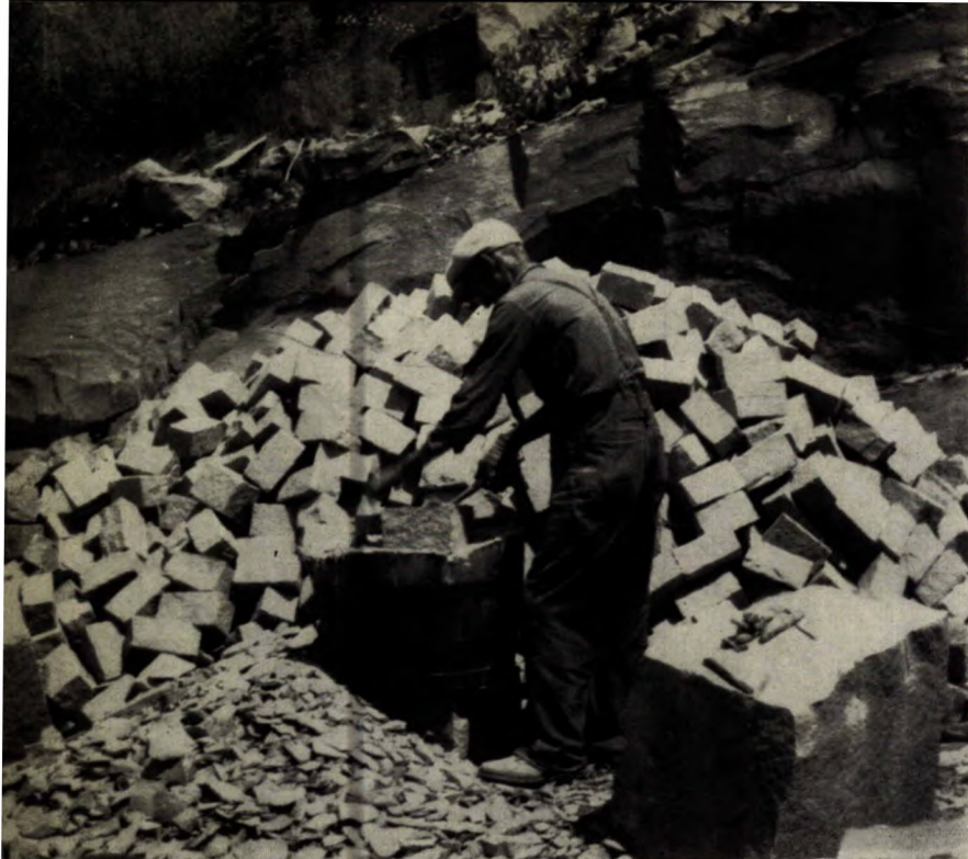
Figure 17 | Ouvrier taillant des pavés à la carrière de la Brodie's Limited, région de Guénette (P.Q.).
