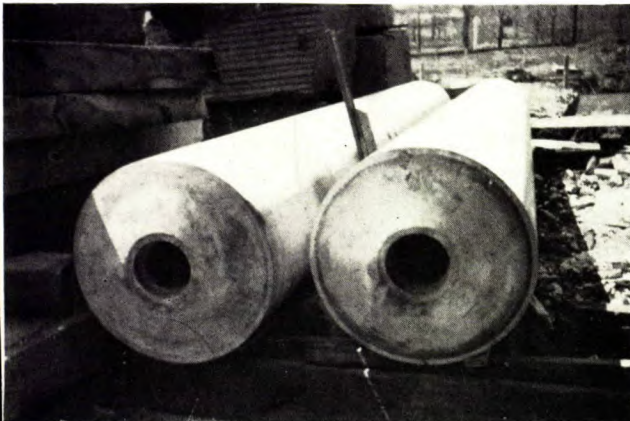
d) Cylindres finis, prêts au montage sur un arbre d'acier.
