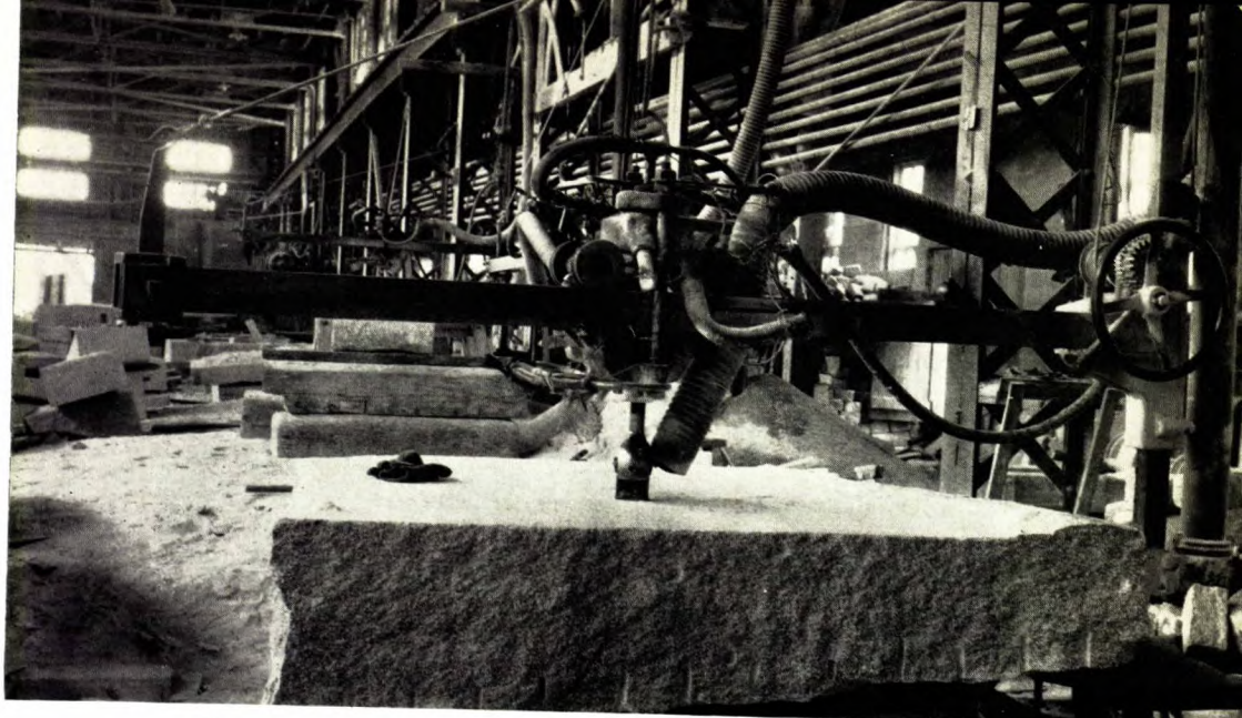
Figure 23 | Machine à surfacer les gros blocs de granit à l'atelier de taille de la Stanstead Granite Quarries Company, Limited, Beebe (P.Q.).
