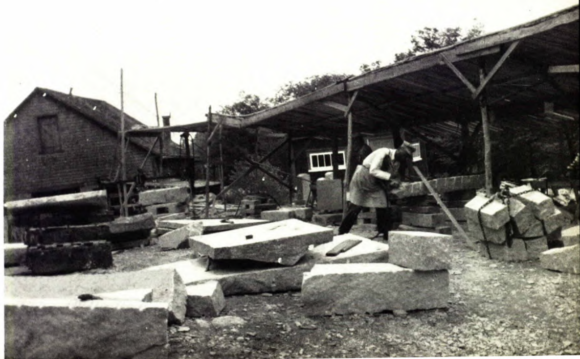
Figure 34 | Taille, à la main, de blocs de granit à la carrière de la St. Samuel Granite, région de Saint-Samuel—Saint-Sébastien (P.Q.).
