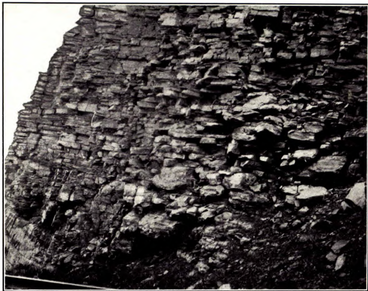
A. Calcaire en couches minces. Ce calcaire est sans valeur pour la construction.
