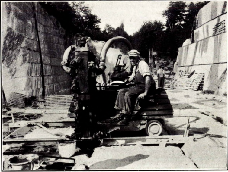
A. Trancheuse électrique à air.
