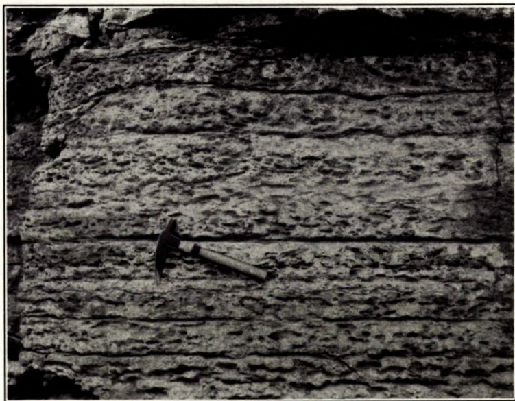
B. Face de calcaire bigarrée abîmée par les intempéries, Haileybury (Ontario). Les trous sont causés par la désintégration de la matière magnésienne formant les bigarrures.
