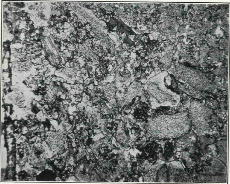
A. Microphotographie du calcaire de Queenston, parallèle à la stratification. Grossissement, 25 fois.
