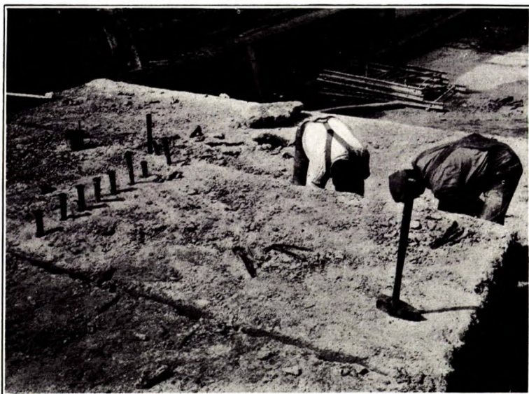
B. Découpage d'un bloc d'atelier à l'aide des aiguilles-coins, à la carrière Gillis, Garson (Manitoba).
