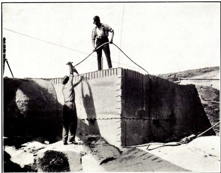
B. Débitage d'un bloc d'atelier à la carrière de Queenston, St. Davids (Ontario).
