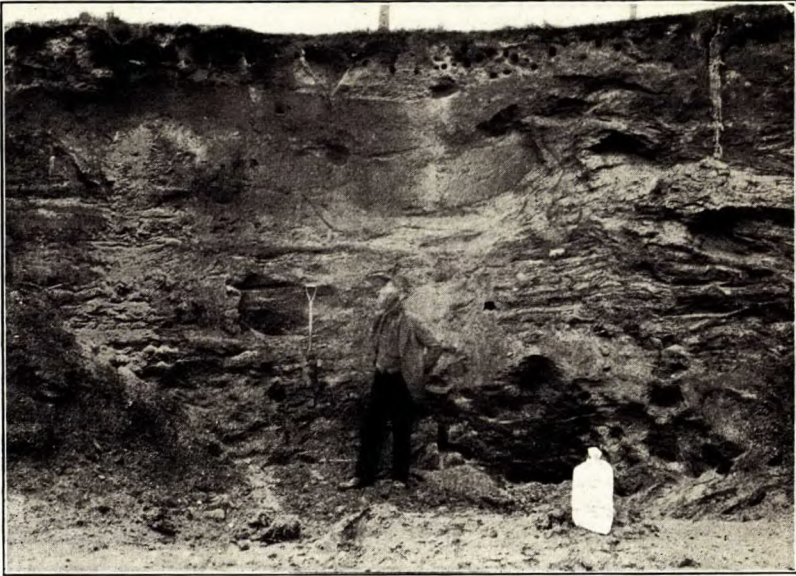
A. Front d'une partie d'un dépôt de sable de moulage sur la ferme de Frank Whippy, près de Belmont, comté de Colchester (N.-E.), montrant la fausse stratification des couches de sable.
