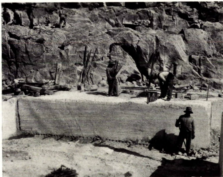
B. Débitage d'un bloc de marbre au moyen de coins. Carrière de la Wallace Sandstone Quarries, Ltd., à Philipsburg, comté de Missisquoi.
