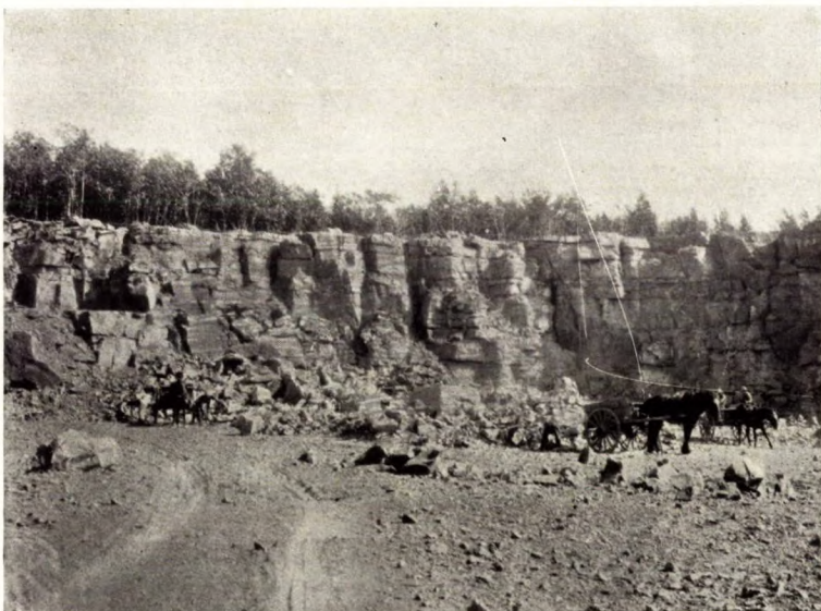
B. Calcaire de Chazy à strates épaisses dans la carrière autrefois exploitée par la Kennedy Construction Co., Ltd., à Saint-François-de-Sales.
