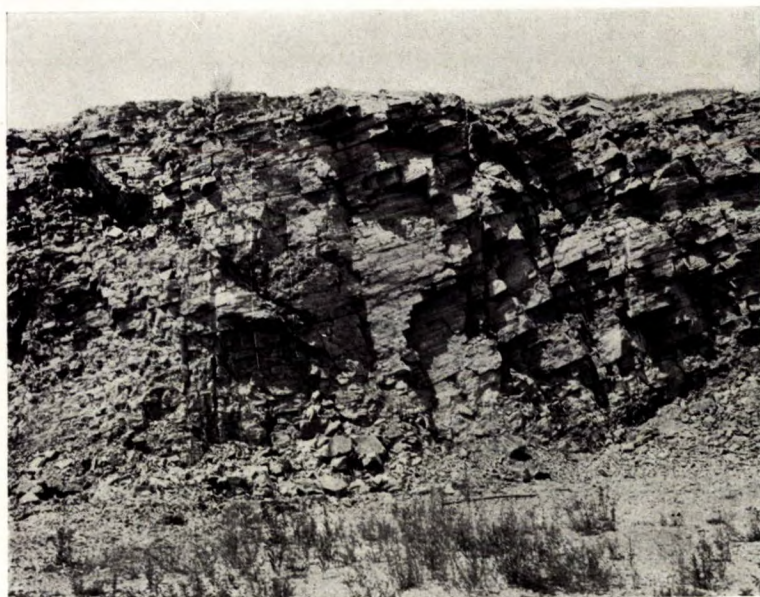
B. Calcaire de Trenton à stratification uniforme dans la carrière de A.-A. Baker, Château-Richer, comté de Montmorency.
