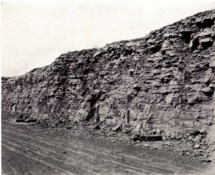
B. Vue de près du calcaire de Trenton à strates minces dans la carrière de la Saint-Barthélémi Quarry Co., Ltd.
