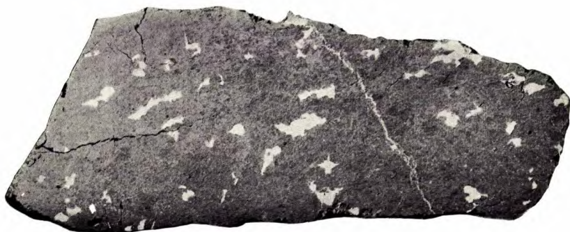
B. Dolomie magnésienne calcinée, montrant quelques cristaux de dolomie.
