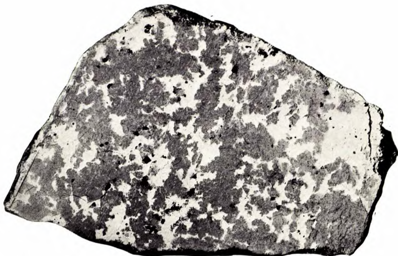
A. Dolomie magnésienne calcinée. La matière foncée est de la magnésite, la matière pâle de la dolomie.
