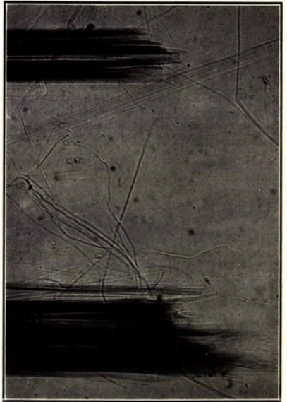
D. Cassure de la fibre du mont Casper, Wyoming, E.-U., grossie 150 fois.
