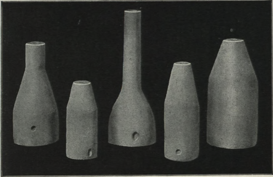
Modèles de phosphorisateurs usités dans la fabrication de bronze au phosphore. (Joseph Dixon Crucible Company, Jersey City, N.-J.).
