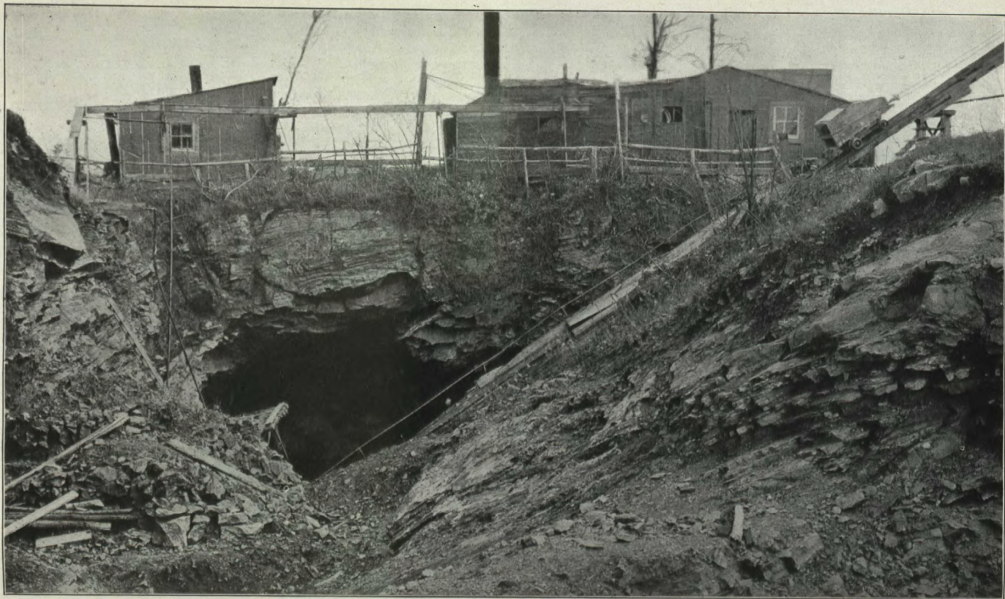
Ciel ouvert surmontant les chantiers de la Globe Graphite Mining and Refining Company, concession VI, lot 21, canton de North Elmsley, Ont. On voit très bien le fasciage dans le calcaire et l'on aperçoit un pli distinct dans la roche de couverture au-dessus du puits. Les gites de graphite ont une tendance à se trouver à la crête de ces sortes de plis.
