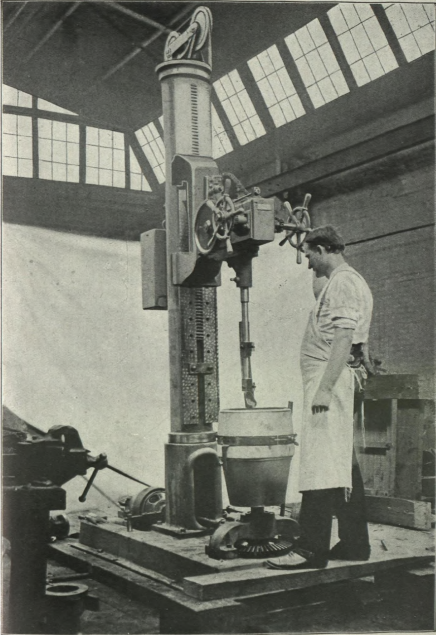
Machine "Pull-down and Jigger" servant à la fabrication des creusets. (Crossley Machine Company, Trenton, N.-J.). La gravure fait voir le profil d'un outil en position pour être abaissé dans le moule au moyen de la roue du côté droit. La roue de gauche sert à régler le mouvement de l'outil en sens horizontal, afin de presser l'argile contre la paroi du moule.
