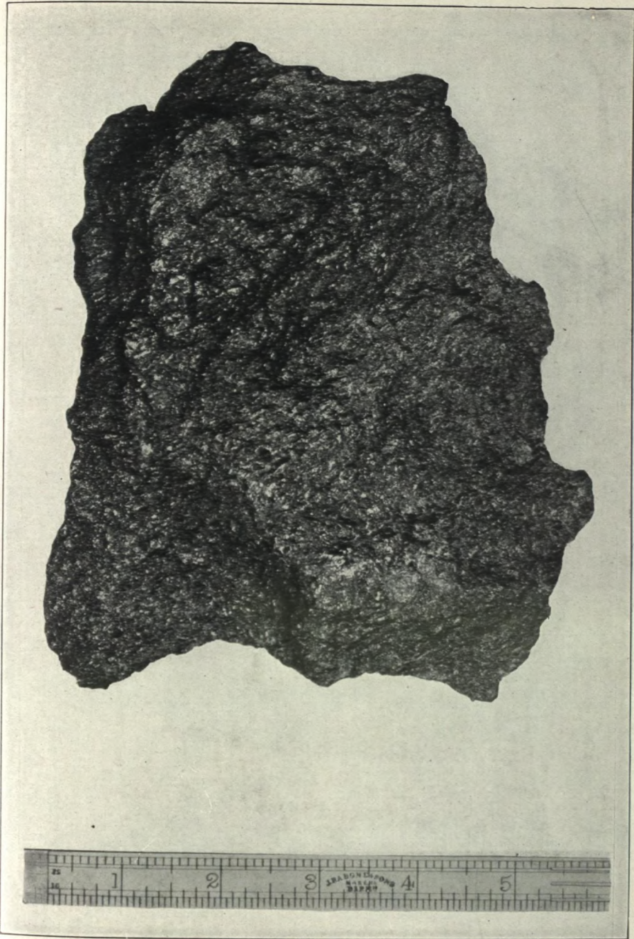
Echantillon type de minéral de graphite laminaire canadien de haute teneur (15-20 p.c. de carbone), du district de Buckingham, Qué.
