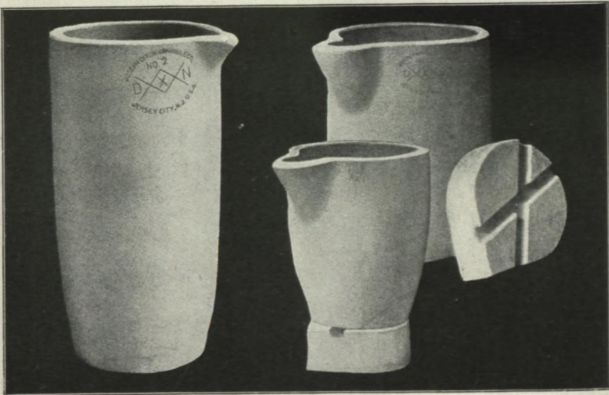
Modèles de creusets utilisés dans un four à bascule. (Joseph Dixon Crucible Company, Jersey City, N.-J.).
