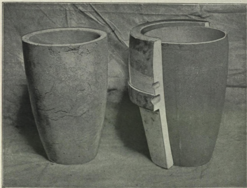
Creusets une fois retirés des moules. (Crossley Machine Company, Trenton, N.-J.)
