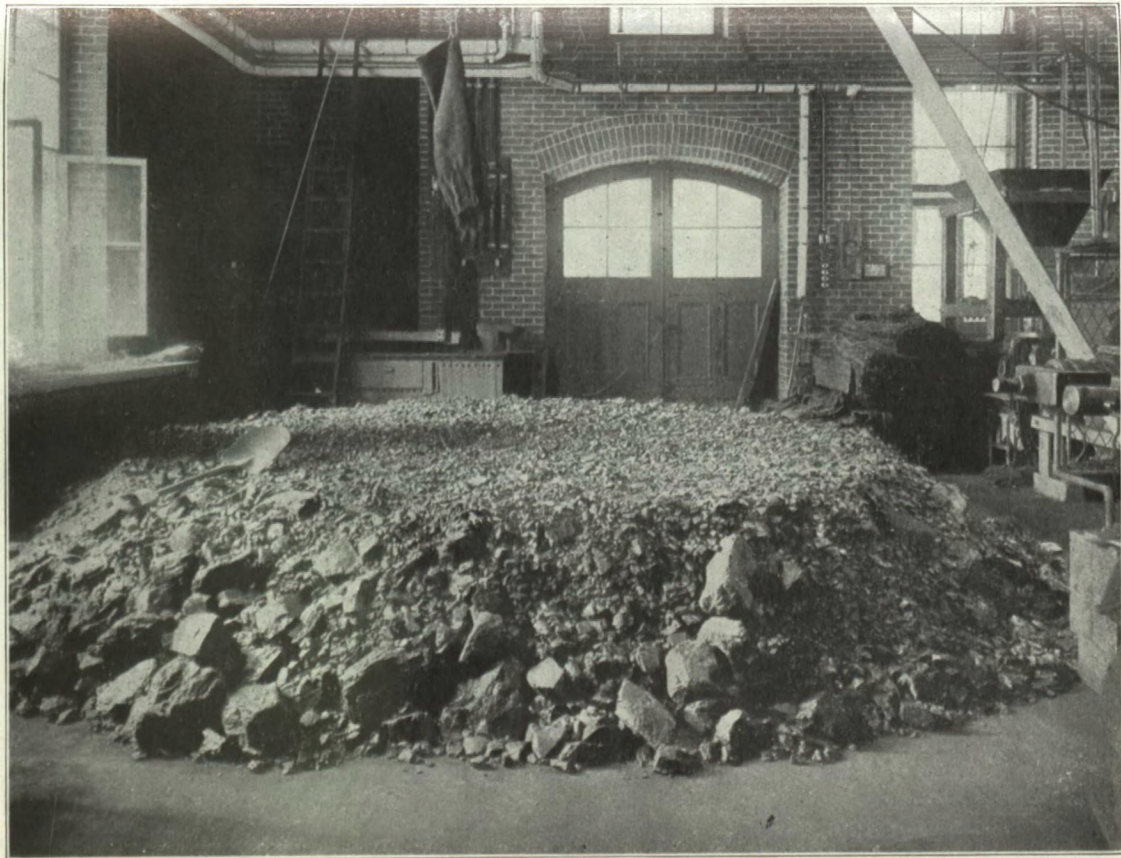
Echantillonnage—un cône de houille aplati—Section des Mines et de la Préparation des minerais, Université McGill.
