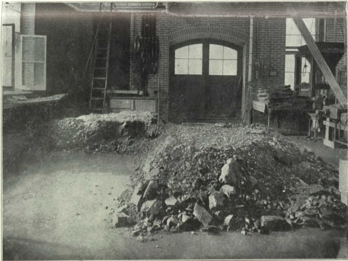
Echantillonnage—une pile de houille réduite en morceaux.—Section des Mines et de la Préparation des minerais, Université McGill.
