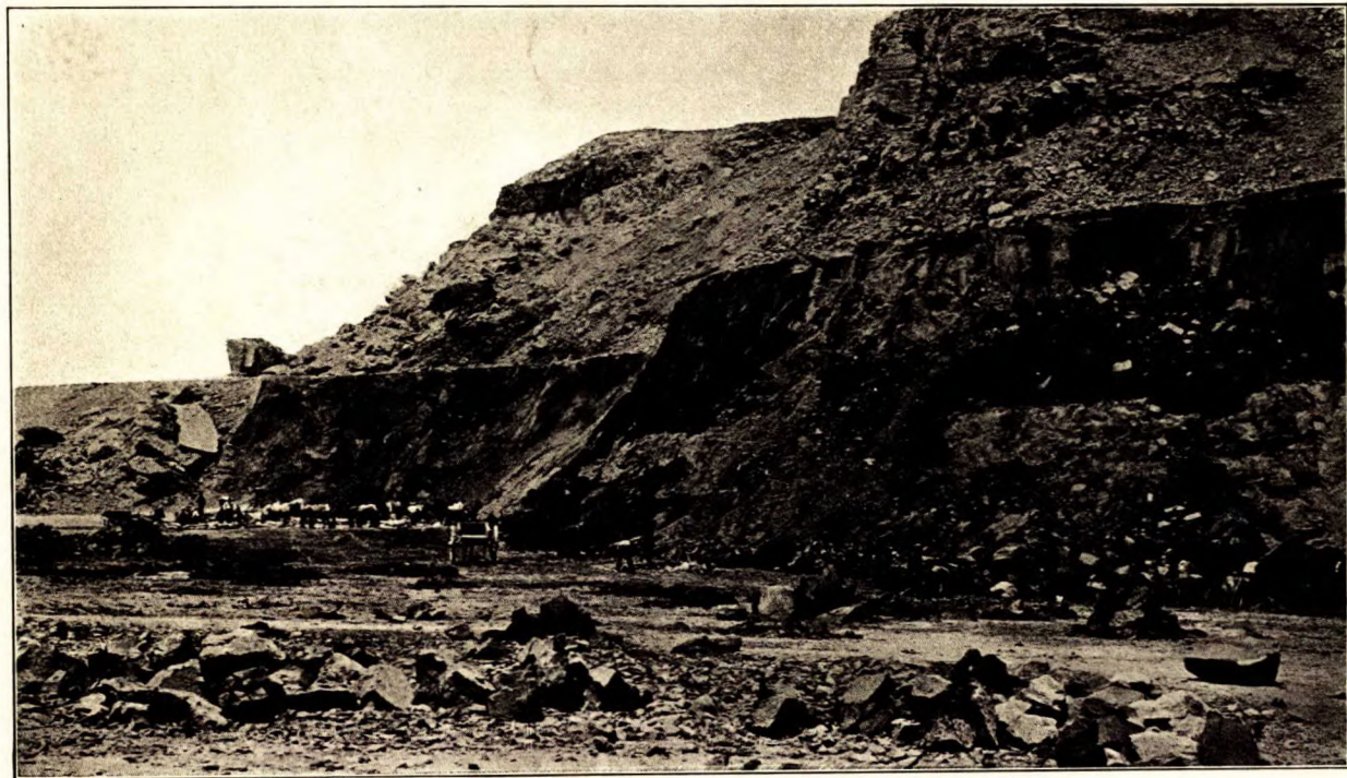
Carrière—type de pierre à sable bitumineuse, exploitée par la City Street Improvement Co., près de Santa Cruz, Cal., E.U.A. Épaisseur moyenne de la roche bitumineuse, environ 60 pieds. Manteau stérile consiste d'argiles Monterey, dures, et de 40-60 pieds d'épaisseur.
