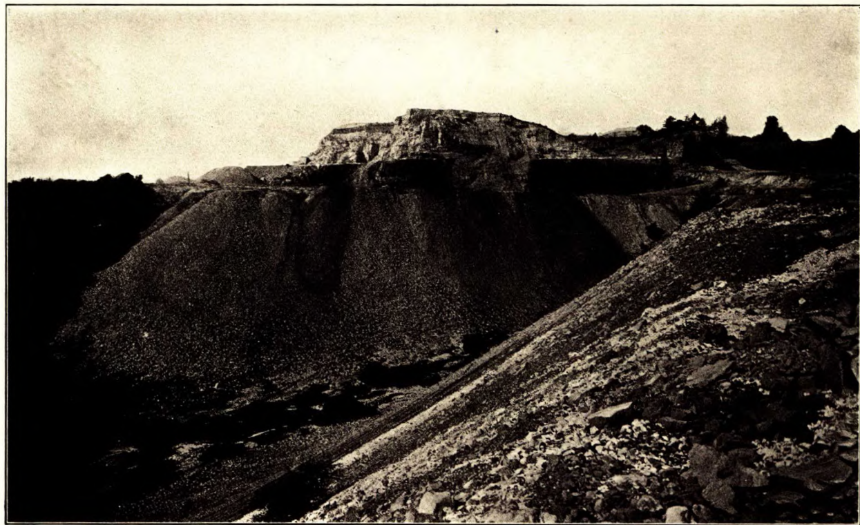
Vue générale d'une carrière de pierre à sable bitumineux, exploitée par la City Street Improvement Co., près de Santa Cruz, Cal. Epaisseur moyenne de la roche bitumineuse, 60 pieds. Manteau stérile, schistes argileux durs de 40-60 pieds d'épaisseur. Production de cette carrière pour l'année finissant le 31 avril, 32, 853 tonnes.
