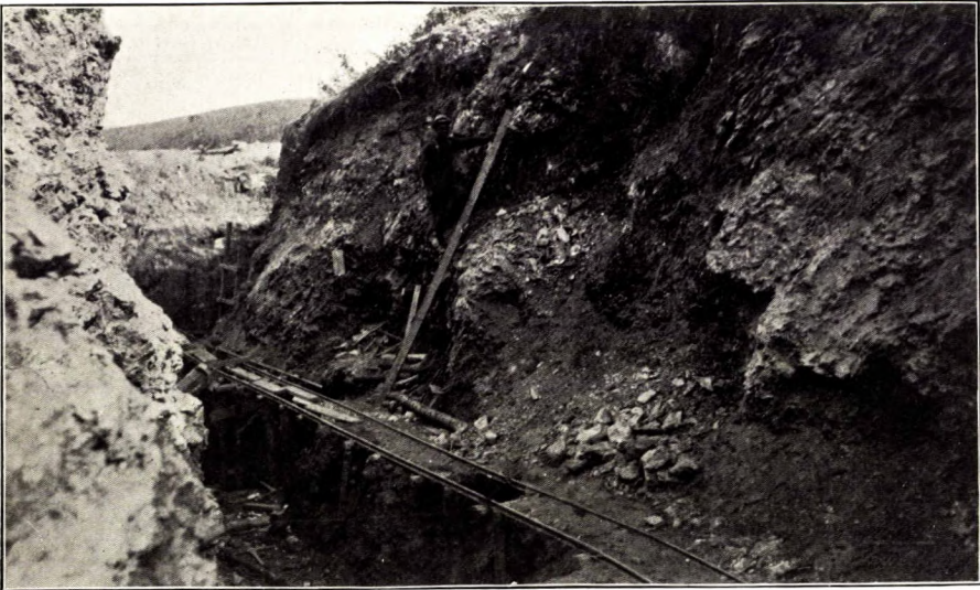
Tranchée à ciel-ouvert, mine Lone Star, coulée Victoria, montrant des lentilles de quartz dans les schistes.
