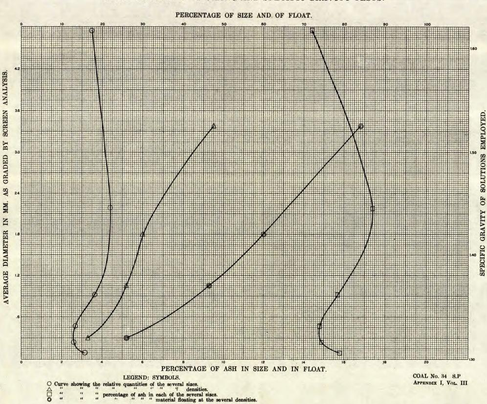
GRAPHIC RECORD OF SIZING AND SPECIFIC GRAVITY TESTS.
