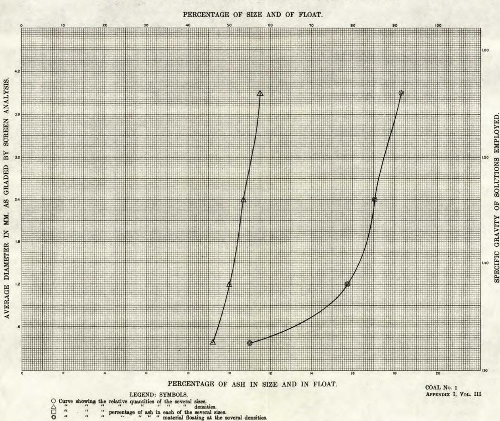
GRAPHIC RECORD OF SIZING AND SPECIFIC GRAVITY TESTS.
