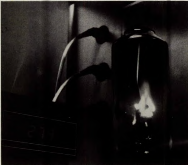
Appareil de mesure de l'indice d'oxygène qui permet d'évaluer l'inflammabilité des courroies de transport
