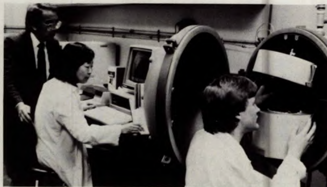
Dr K.K. Feng (chercheur scientifique) utilise le calorimètre à taux accéléré pour tester la stabilité thermique des explosifs
