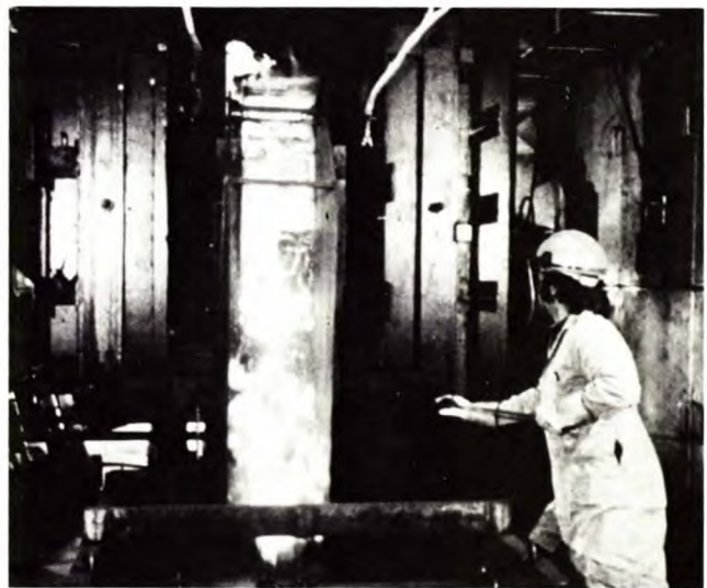
Fabrication du coke métallurgique dans le four à échelle-pilote (310 mm de diamètre) de CANMET
