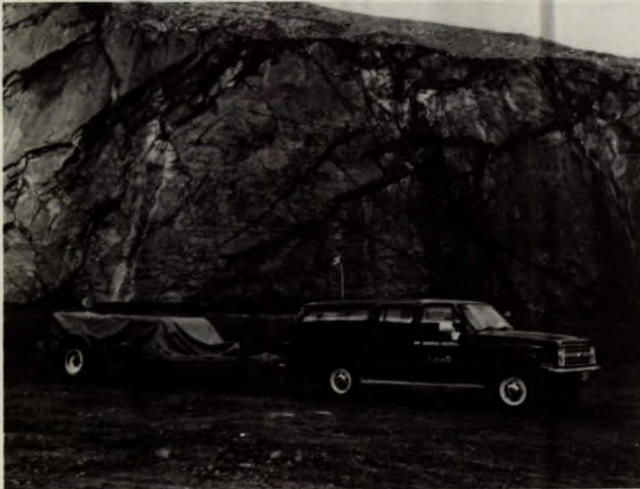
Remorque du Laboratoire d'exploitation à ciel ouvert de CANMET, utilisé pour mesurer les résistances au roulage dans une mine de charbon à ciel ouvert de l'Ouest canadien
