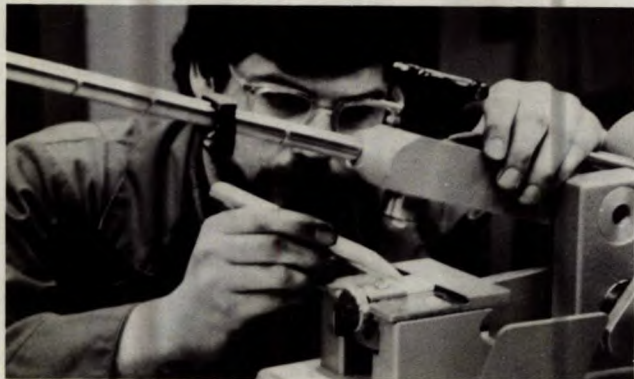
Don Cox (technologue) fait l'essai d'un explosif brisant sur une machine à friction BAM
