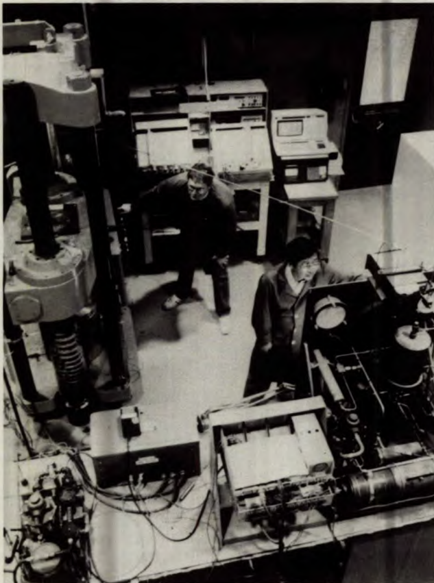
Rand Jackson et Ah-Soo Wong (physiciens) effectuent des essais triaxiaux rigides sur un cadre portant une charge de 300 000 lb et sur un panneau à pression confiné
