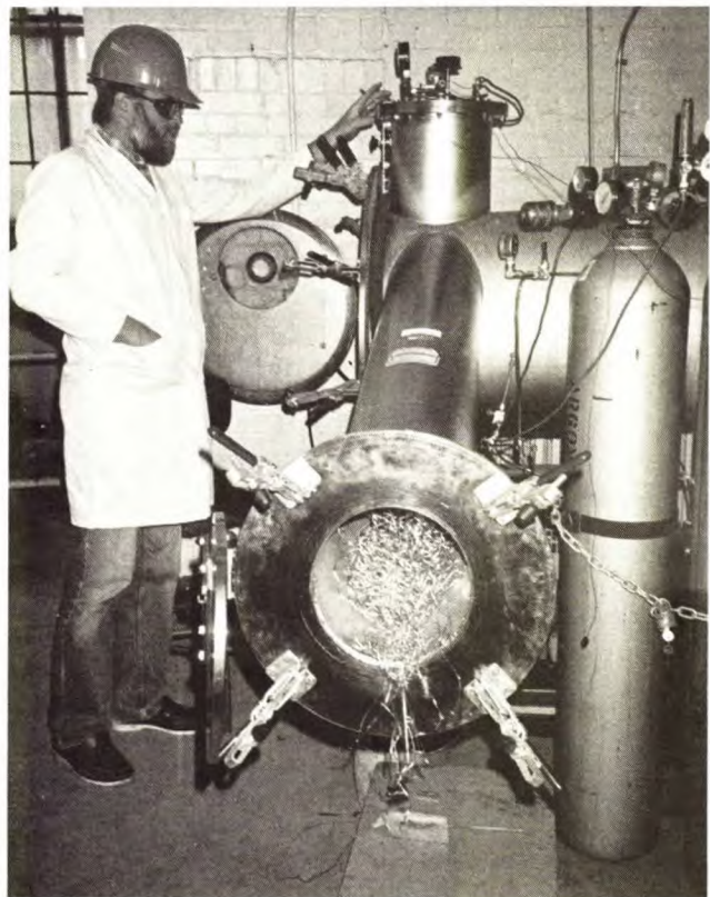
Jim Barry, technologiste, utilise un appareil d'emboutissage au tour afin de produire un ruban à partir d'un alliage aluminium bronze expérimental à l'état liquide, à l'aide du procédé de solidification rapide (10 6 C/sec)
