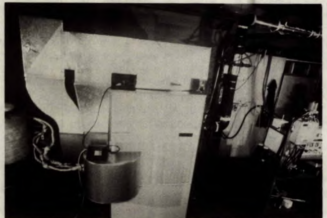
Appareil expérimental utilisé pour évaluer les effets de la qualité du combustible sur la performance d'un brûleur à combustible liquide
