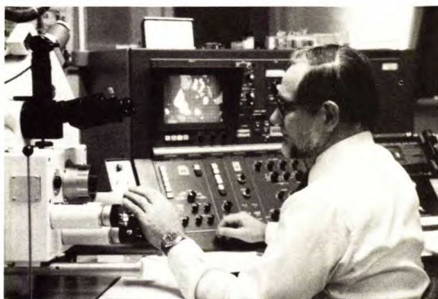
Analyseur d'images utilisé avec un microscope électronique à faisceau et un produit-programme complexe pour analyser les éléments contenus dans un minerai et déterminer la dimension des grains ainsi que le broyage nécessaire afin de libérer les minéraux précieux contenus dans le minerai
