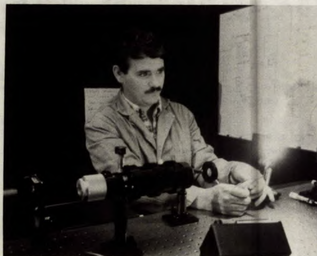
Chris Hughes, technicien, fait une étude de flammes à l'aide du laser Schlieren
