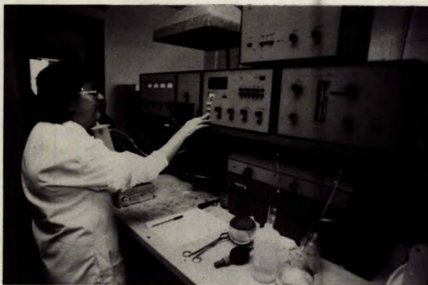
Elsie Donaldson, scientifique de la recherche, utilise un spectrophotomètre d'absorption atomique pour l'analyse des éléments-trace
