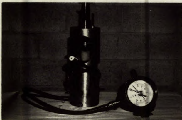
Appareil Robertson pour des essais de charge concentrée sur les roches
