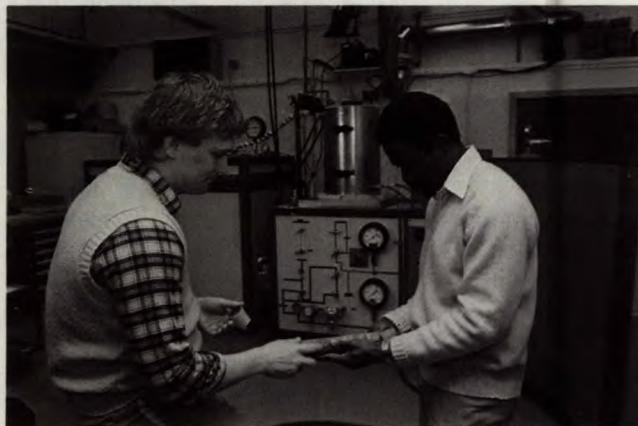
Scientifiques examinant des échantillons de roche soumis à un essai de perméabilité
