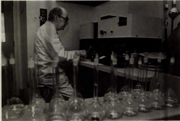
*R. Craig, chimiste, utilise un spectrophotomètre d'absorption atomique pour l'analyse de la teneur en métal du minerai*
