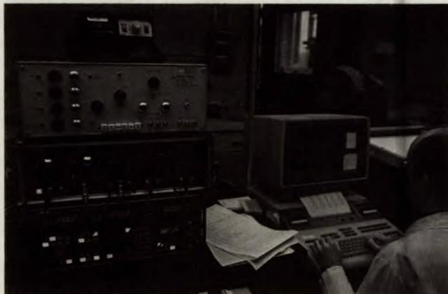
Matériel utilisé pour le contrôle automatisé de la conductivité électrique des céramiques. G. McDonald, opérateur
