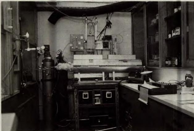
*Appareil électrochimique utilisé dans le laboratoire de Jim Skeaff, scientifique de la recherche, pour déterminer les propriétés thermodynamiques des arséniures*
