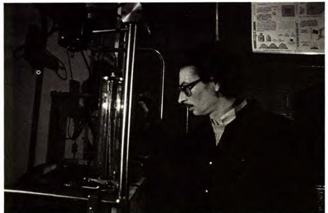
*Le technologue C.A.W. McNabb met en marche une unité de distillation à parcours de temps limité servant à la séparation des produits provenant de l'usine pilote d'hydrocraquage du CANMET*
