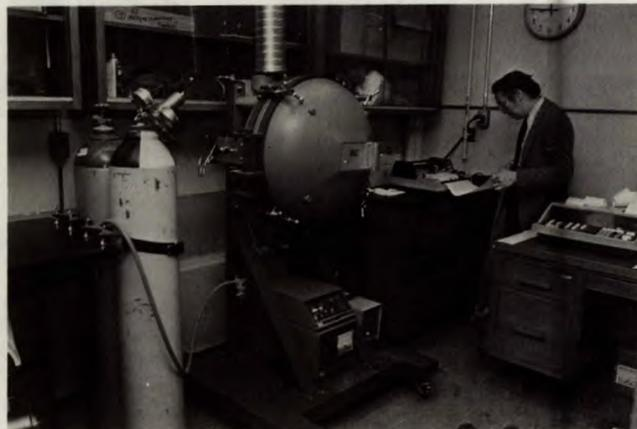
*Scientifique utilisant un calorimètre accéléré au Laboratoire de recherche sur les explosifs*
