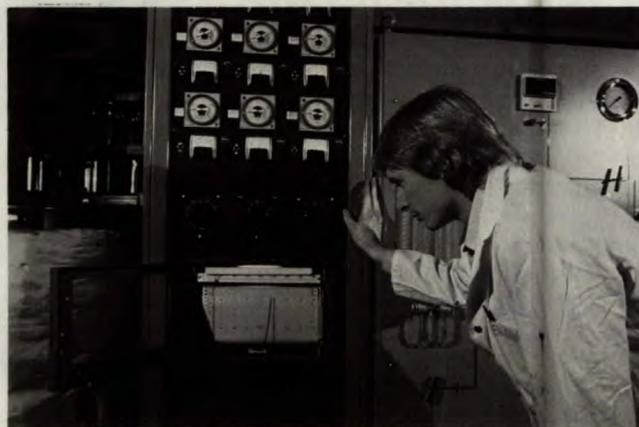
*John Margeson règle la soupape d'une installation expérimentale utilisée pour l'étude de la récupération du bitume des sables asphaltiques d'Athabasca*
