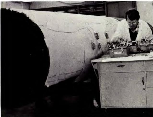
Figure 2. Le diamètre des larges tubes de gazoducs est impressionnant. Ce technicien mesure, à l'aide d'extensomètres, les tensions internes dans un tube de 42 po (106 cm) de diamètre et de 0,54 po (13,7 mm) d'épaisseur.
