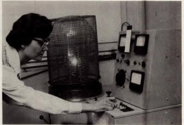
Figure 12. La préparation des spécimens pour l'examen au microscope électronique fait appel à des techniques spécialisées. Cette technicienne prépare une réplique d'extraction en film de carbone d'un acier à rail, qui sera examinée avec un très fort grossissement.
