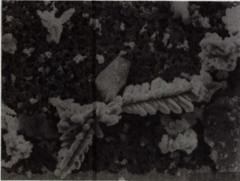
Figure 6.29b – Photographie par microscopie électronique à balayage de particules d'or précipitées par hydrogénation (50 °C, 70 kPa H 2 , platine platiné).
