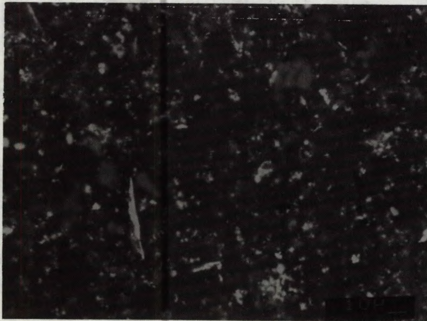
Figure 6.31b – Photographie par microscopie électronique à balayage d'une section polie. Diffusion à faisceau inversé.
