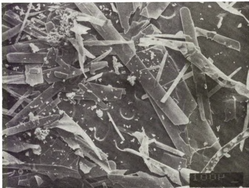
Figure A.1 – Aspect des produits de précipitation d'une solution de thiourée. Microscope électronique
