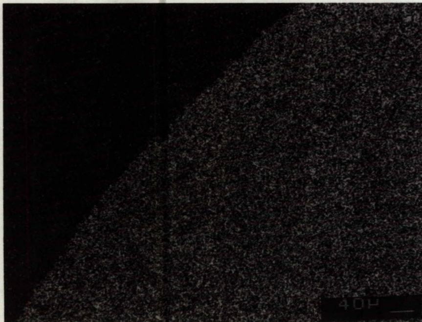
Figure B.5 - Analyse du soufre par diffusion inversée du faisceau ( Sk\alpha )
