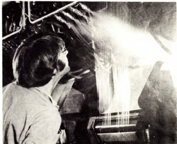
Fig. 15 - Fabrication de fibres de verre à partir de mélange fondu (34)
